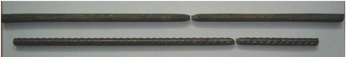
Şekil 4.15. Çekme deneyinde kullanılan Ø8-Ø6 mm numune
