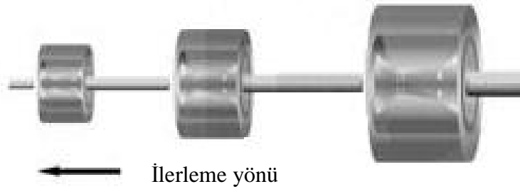
Şekil 1.2. Telin matristen geçişi (Element Six, 2006)
