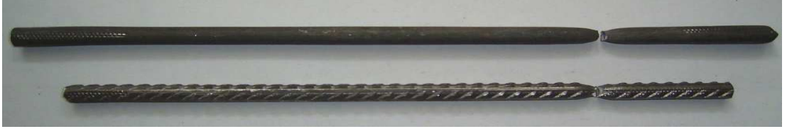
Şekil 4.20. Çekme deneyinde kullanılan v=3.6 m/s hızla çekilen numune
