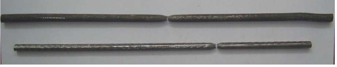
Şekil 4.24. Çekme deneyinde kullanılan \text{Ø}7\text{-Ø}6 mm v=5 m/s hızla çekilen numune
