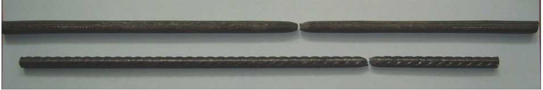
Şekil 4.14. Çekme deneyinde kullanılan Ø8-Ø6 mm numune
