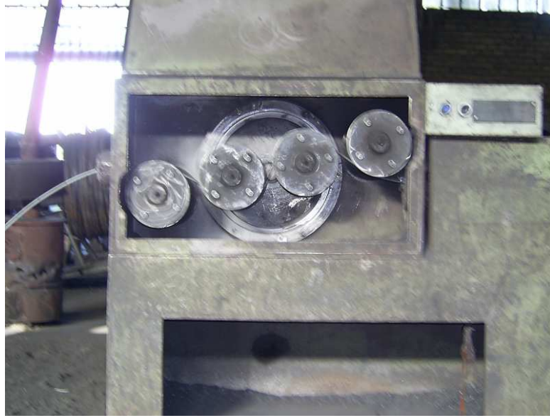
Şekil 3.1. Makaralarla mekanik yüzey hazırlama (Ayes A.Ş)
