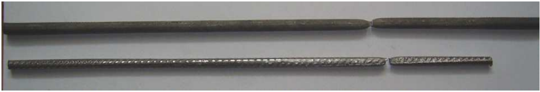
Şekil 4.10. Çekme deneyinde kullanılan \text{Ø}6\text{-Ø}4.5 mm numune
