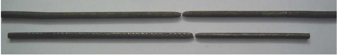
Şekil 4.9. Çekme deneyinde kullanılan \text{Ø}6\text{-Ø}5 mm numune
