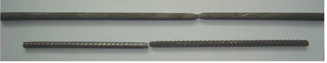
Şekil 4.25. Çekme deneyinde kullanılan \text{Ø}7\text{-Ø}5,5 mm v=2.4 m/s hızla çekilen numune
