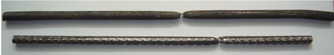
Şekil 4.4. Çekme deneyinde kullanılan SAE 1008 numune
