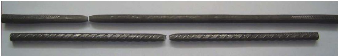
Şekil 4.5. Çekme deneyinde kullanılan SAE 1010 numune
