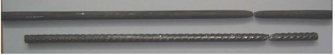
Şekil 4.19. Çekme deneyinde kullanılan v=2.4 m/s hızla çekilen numune
