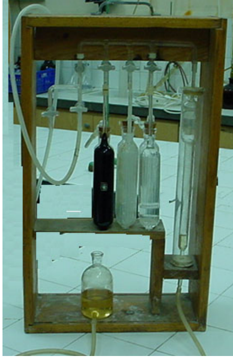
Şekil 3. 2 Orsat-tipi gaz analiz cihazı
