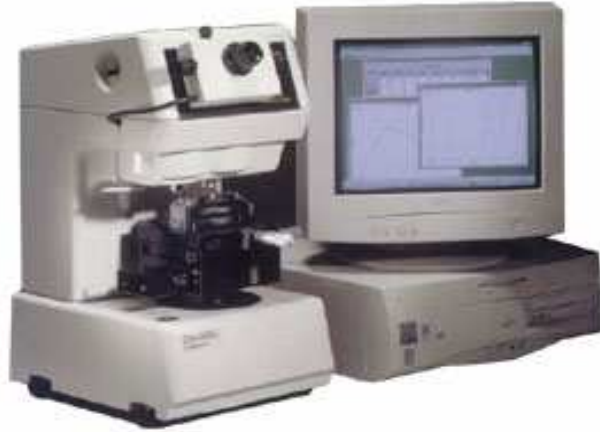
Şekil 3.5 Sertlik deneyleri için kullanılan DUH-W201S'nin genel görünümü ( http://www1.shimadzu.com/products/test/hardness/duh201.html )
