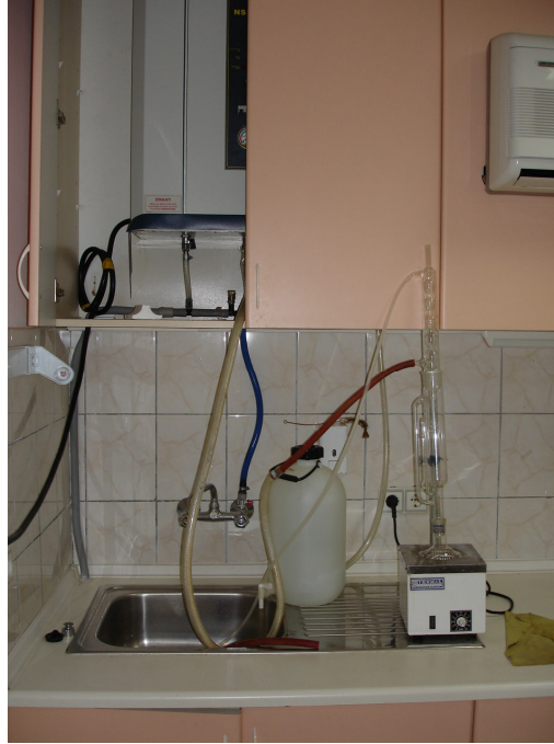
Şekil 3.1 Distilasyon Düzeneği (Antalya Çevre İl Müdürlüğü Laboratuvarı, 2005)
