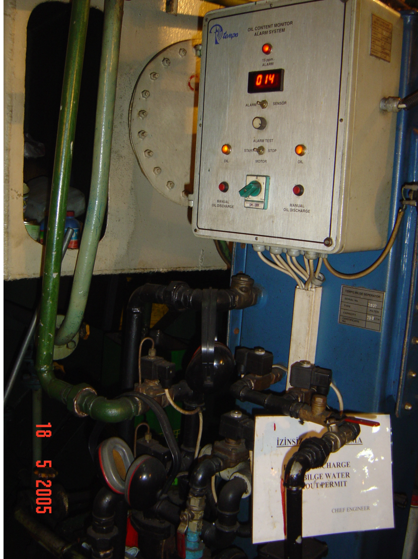
Şekil 7.6 Makkaçkab adlı sıvı yük gemisine ait Oil Discharge Monitorü, 2005
