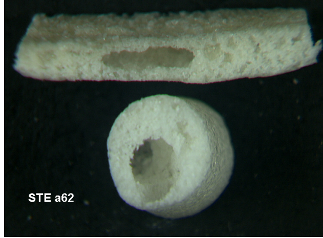
Şekil 4.57. Tribütirin DBC ile homojen olarak karışmadığında karşılaşılan durum
