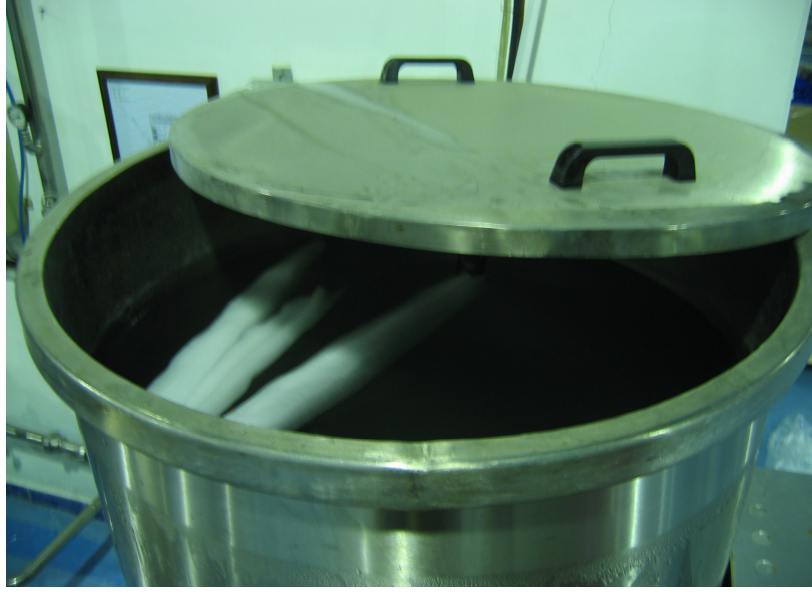
Şekil 3.2.1.4. Ön soğutma ve ozon uygulamasının yapıldığı su tankının üstten görünüşü
