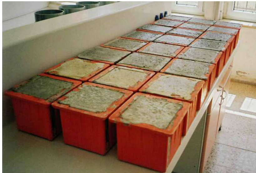
Şekil 3.9. Birim hacim ağırlık deneyleri yapılan kalıba dökülmüş beton numuneleri
