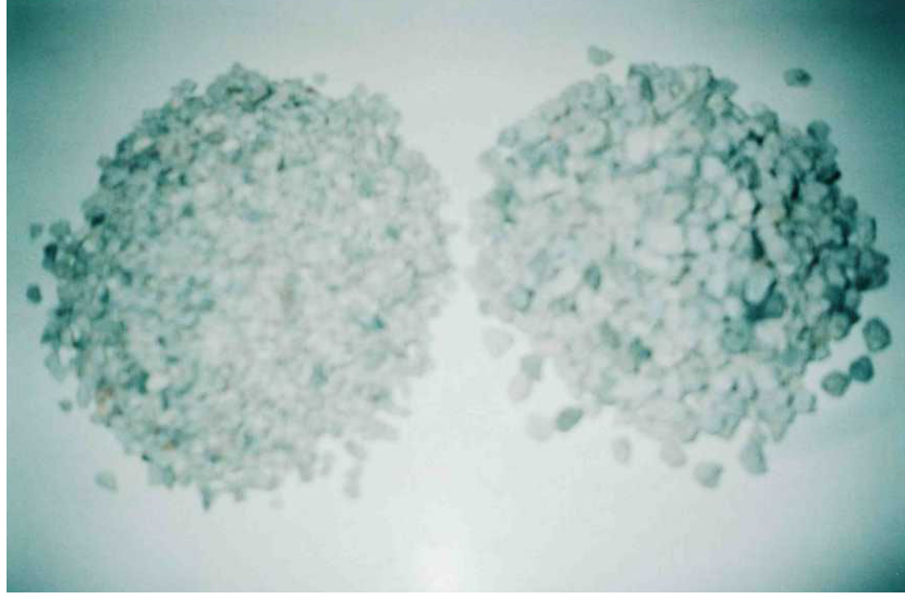
Şekil 3.2. Atık betonun kırılmasıyla elde edilen agreganın görüntüsü
