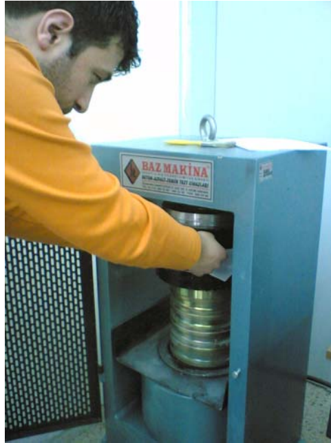
Şekil 3.10. Tek eksenli basınç dayanımı deney düzeneği
