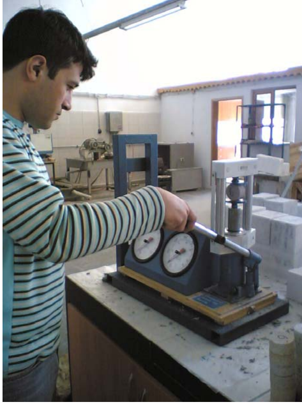
Şekil 3.12. Brazilian deneyinin ölçümü için kullanılan düzenek
