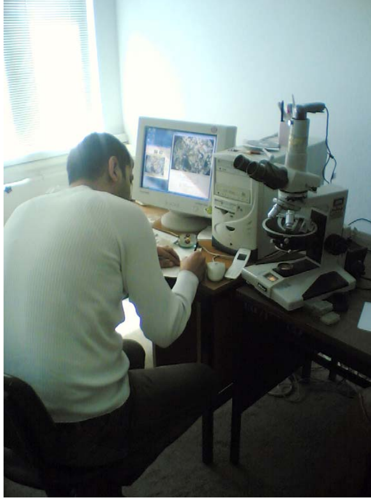
Şekil 3.5. Hazırlanan ince kesitlerin görüntülerinin bilgisayar ortamına aktarılması
