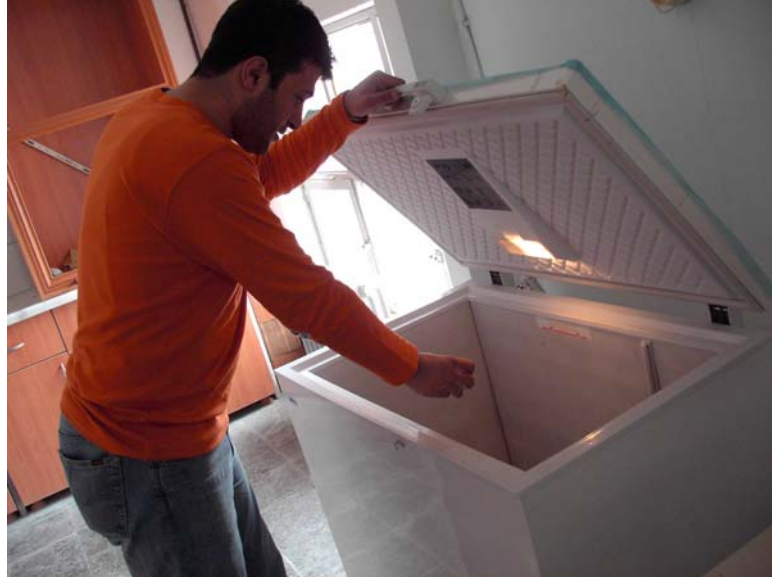
Şekil 3.8. Donma –çözülme deneyinde kullanılan derin dondurucu
