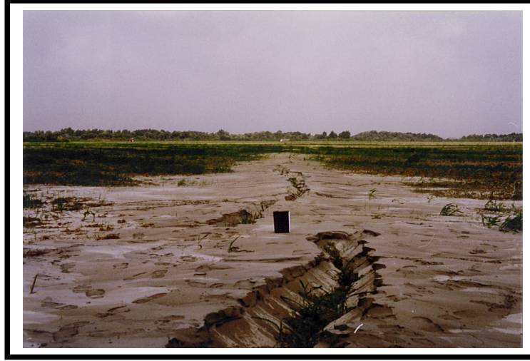
Şekil 2.3. 1998 Ceyhan depreminde sıvılaşma sonucu oluşmuş yanall yayılma
