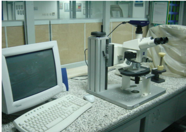
Şekil 3.2.5.2. Zeiss HAL-100 marka optik mikroskop
