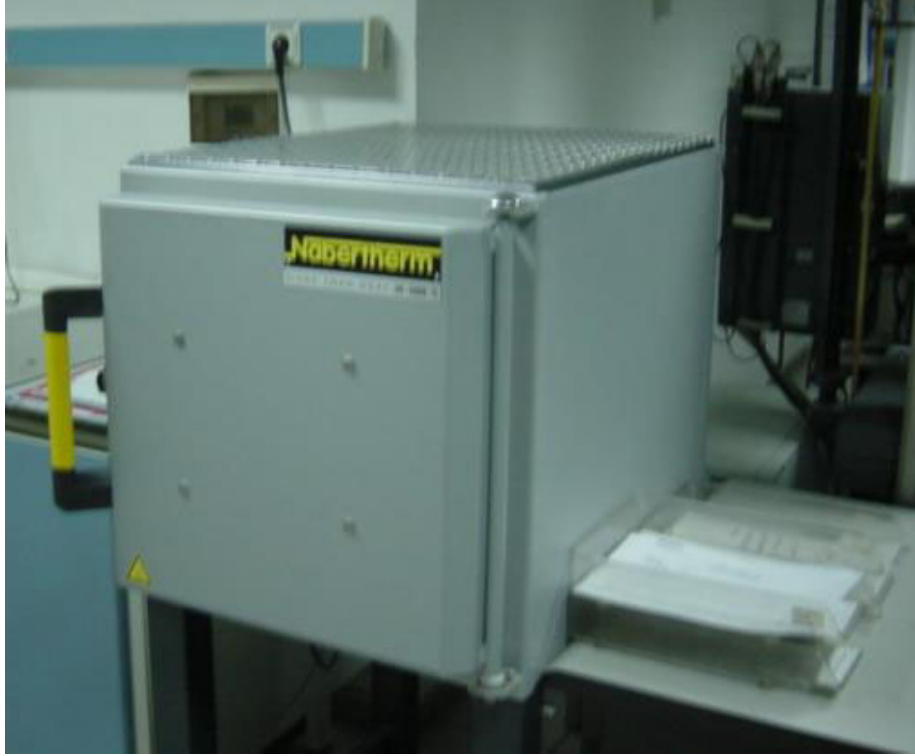
Şekil 3.2.1.1. Nabertherm N 30 / 65 HA ısıtma fırını(Assan Alüminyum Tesisleri )
