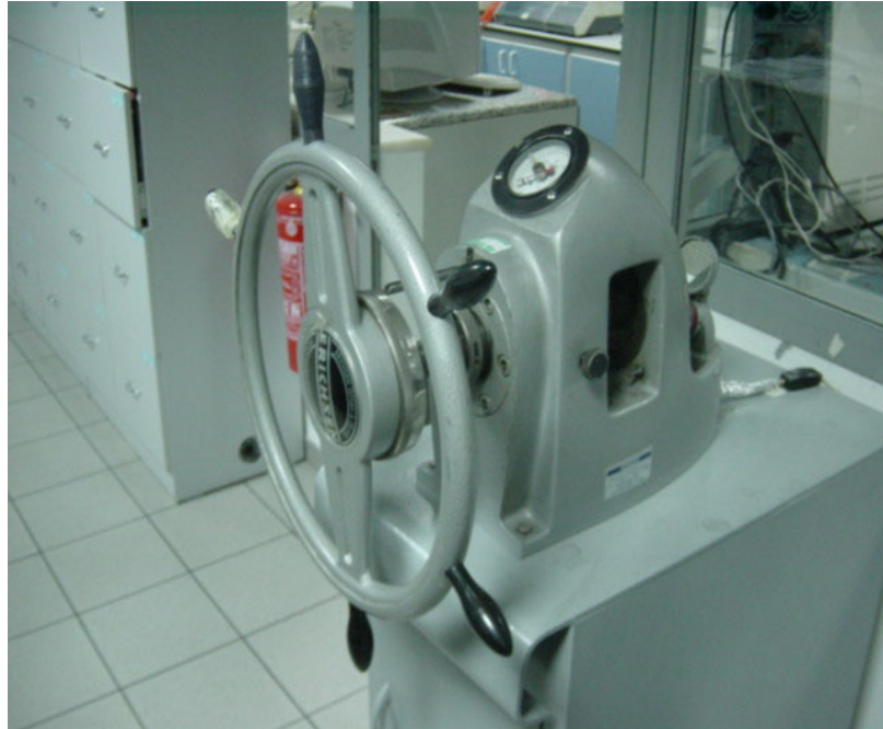
Şekil 3.2.3.1. Erichsen test cihazı (Assan Alüminyum Tesisleri)
