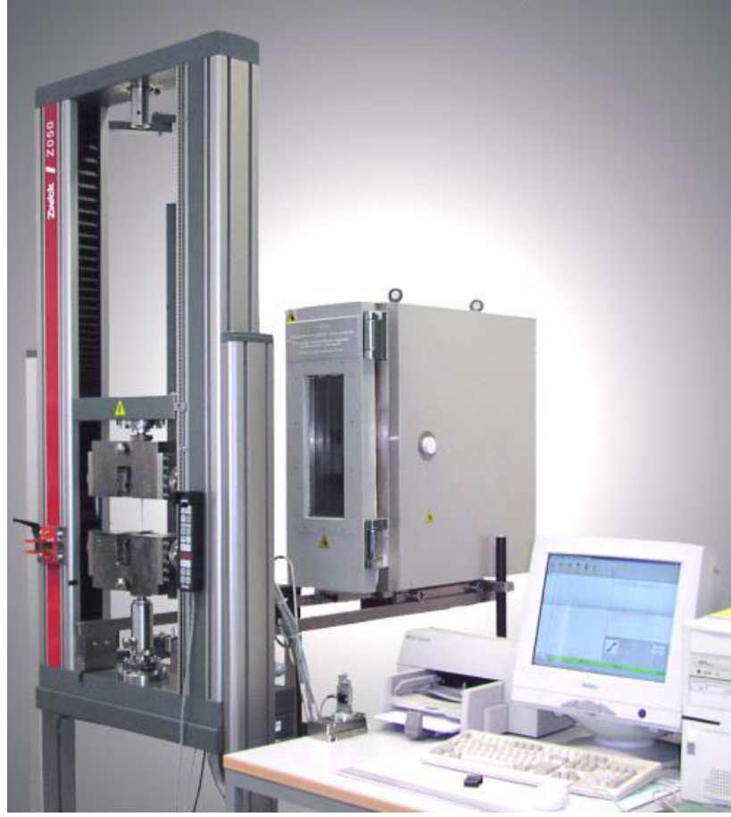
Şekil 3.2.2.1 Zwick Z050 çekme cihazı (Assan Alüminyum Tesisleri)
