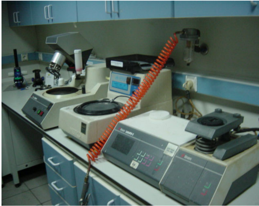
Şekil 3.3.6.1. Mikro yapı incelemeleri için , numunelerin hazırlanmasında kullanılan sistemler(Struers Labopol – 5 , Metkon Gripo 200-IV , Struers Lectropol – 5 )(Assan Alüminyum Tesisleri)
