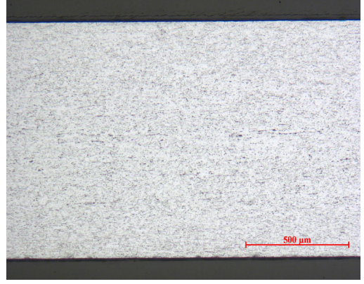
Şekil 4.7.17. AA 5754 alaşımının 380 0 C' de 4 saat tavllanmış numunenin iç yapısı (pl-bw)
