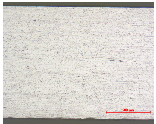
Şekil 4.7.22. AA 5754 (HT) alaşımının haddelenmiş - tavsız numunenin iç yapısı (pl-bw)
