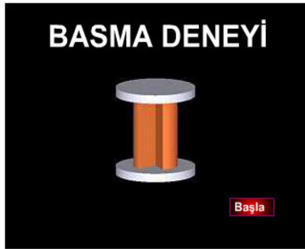
Şekil 4.7.3.1. Kesit görünüşteki numuneye uygulanan basma deneyi başlangıcı ( http://www.deform.com/frame.htm adresinden değiştirilerek alınmıştır, 2004)
