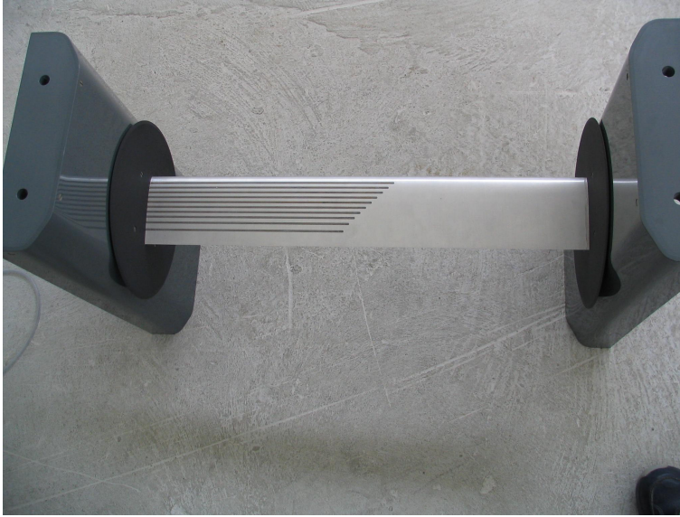
Şekil 3.8. Rüzgar Tüneli Testinde Kullanılan NACA 23012 Profili
