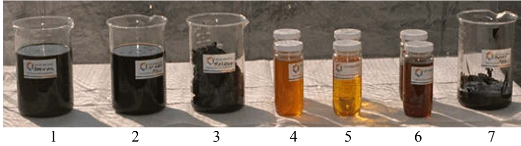
Şekil 3.14. Kullanılmış yağın geri kazanım aşamaları ( http://www.interlineresources.com/introduction.html ).
