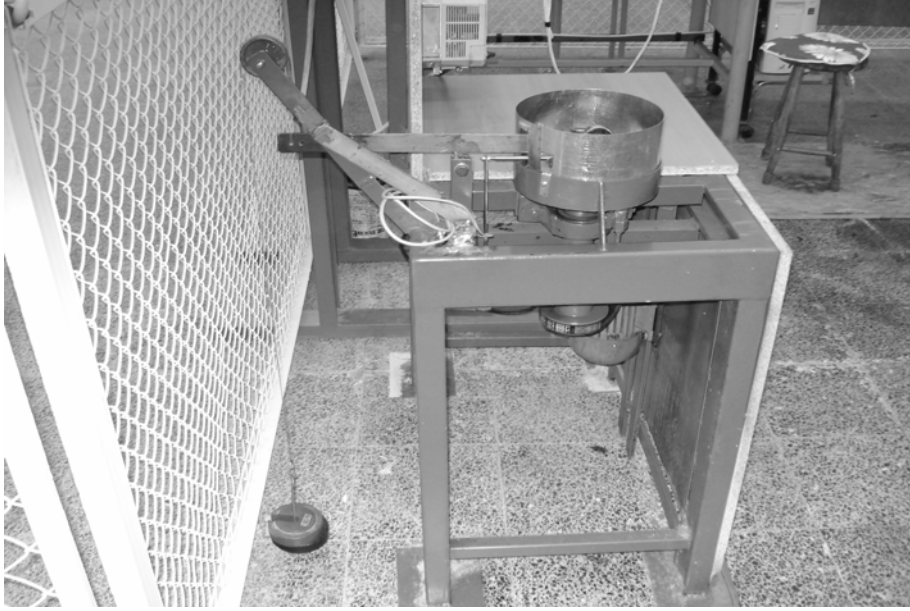
Şekil 4.6. Pim Disk Aşınma deney düzeneğinin fotoğrafı
