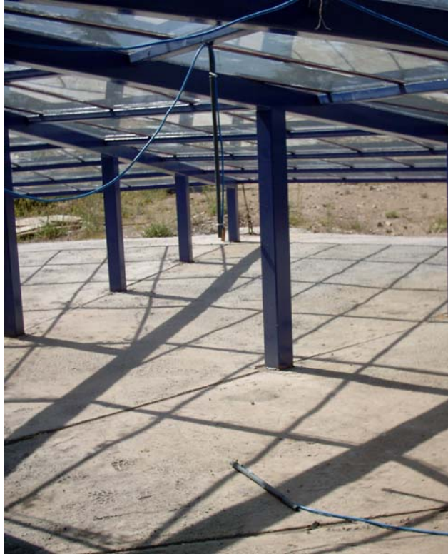
Şekil 3.22. Kollektör giriş ağzından yatayda 3,5 m içeriye doğru, kollektör altındaki ve zemindeki sıcaklık sensörleri
