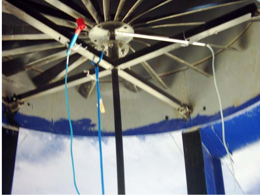
Şekil 3.23. Pervane kısmına yerleştirilen hız ve sıcaklık sensörleri
