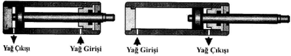
Şekil 3.5. Çift etkili hidrolik silindir (Rohner, 1994)
