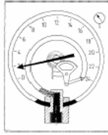
Şekil 3.8. Tüplü manometrenin iç yapısı (Rohner, 1994)
