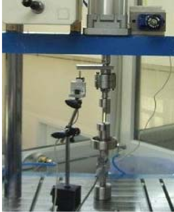
Şekil 3.29. Çekme deneyi çeneleri ve aksenal kaçıklığı gidermede kullanılan flanş
