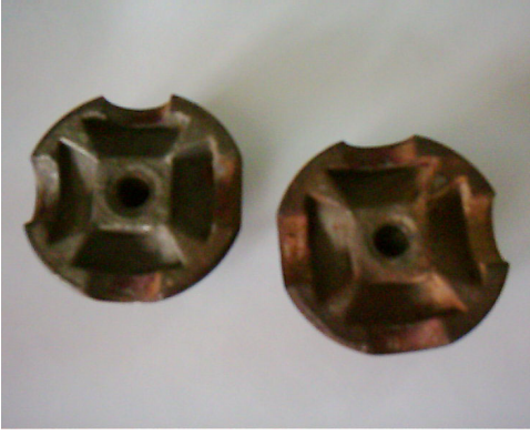
Şekil 3.7. Döküm olarak yapılan bir düğüm sistemi
