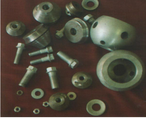
Şekil 3.6. Boş küre düğüm sistemi elemanları
