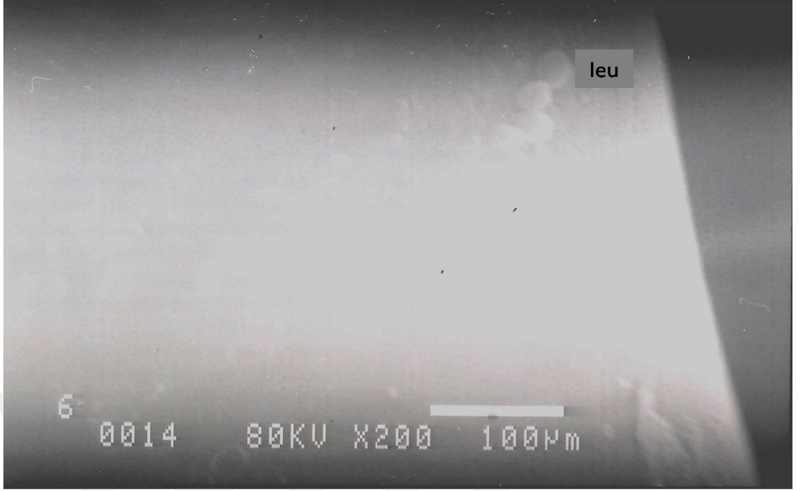
Resim 3. Fosforilkolin kaplamalı oksijenatör fiberinin SEM görüntüsü: fiber yüzeyinde yer yer lökositlerin (leu) varlığı tespit edildi.
