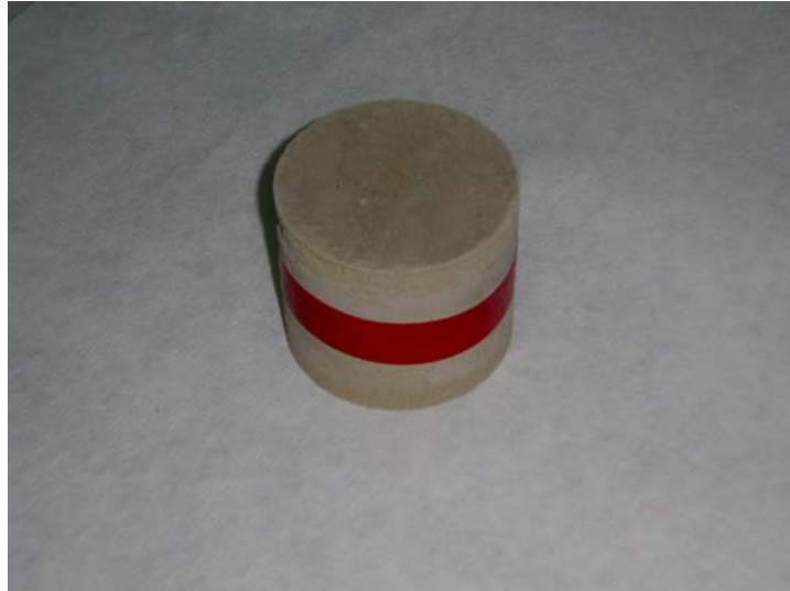
Şekil 3.17. Zemin numunelerinin elektrik bantı kullanılarak bantlanması
