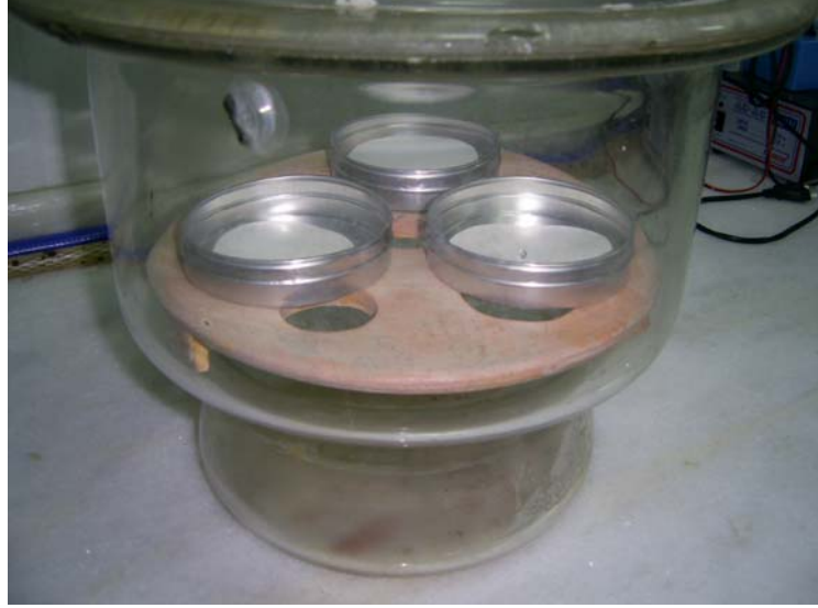
Şekil 3.14. Filtre kağıtlarının nem almasının engellemesi için desikatörde korunması
