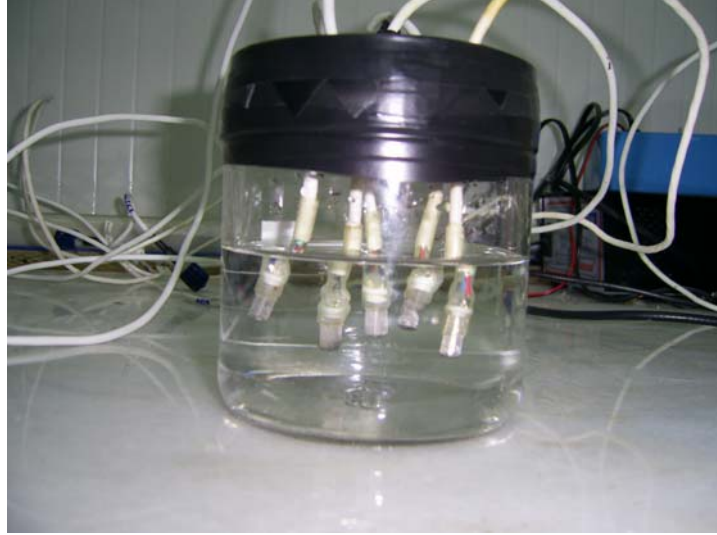
Şekil 3.4. Saykrometrelerin NaCl çözeltisinde kalibrasyonu
