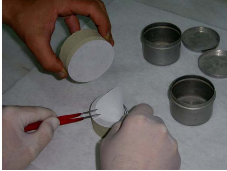
Şekil 3.24. Ortadaki filtre kağıdının alüminyum kutuya alınması
