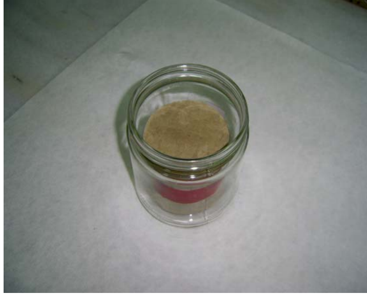
Şekil 3.18. Zemin numunesinin cam kavanoza yerleştirilmesi
