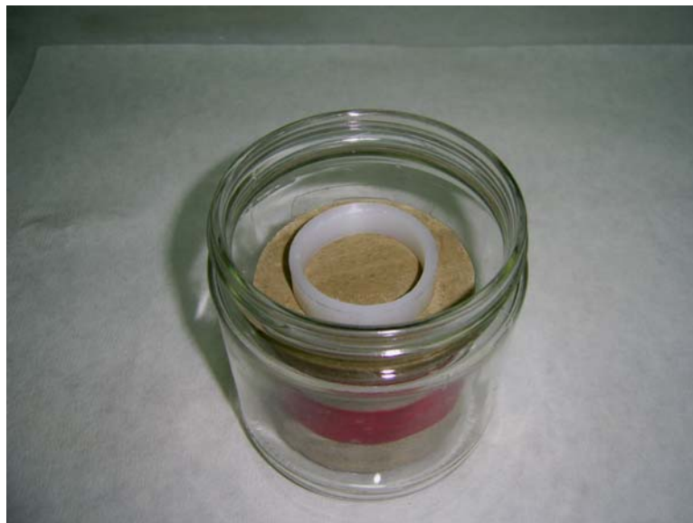
Şekil 3.19. Zemin numunesinin üzerine plastik bir o-ring yerleştirilmesi
