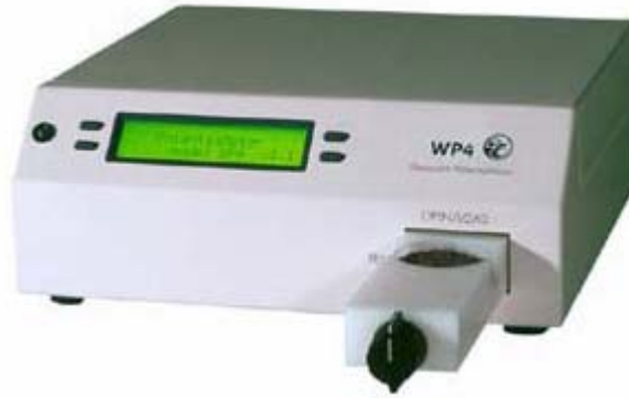
Şekil 2.27. Chilled-Mirror Higrometre (Bulut ve Leong, 2005)
