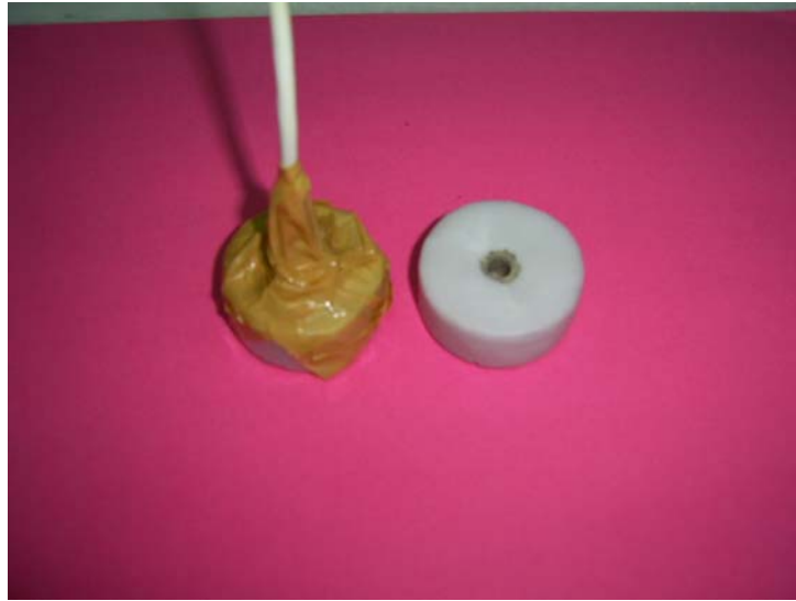
řekil 3.10. Saykrometre deney numunelerinin hazırlanması
