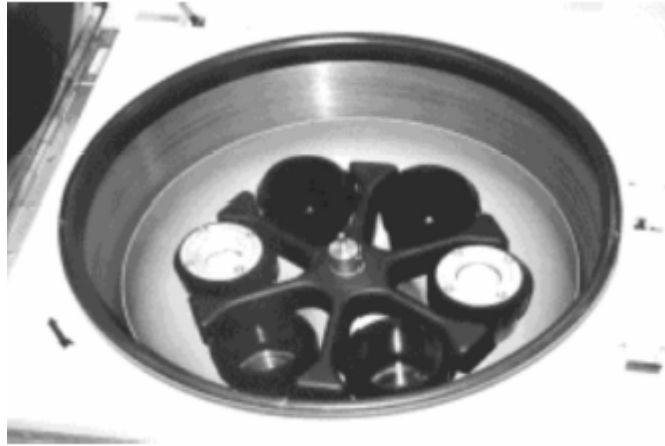
Şekil 2.39. Altı adet hareketli kaptan oluşan küçük tip medikal bir santrifüj düzeneği (Khanzode vd., 2002).
