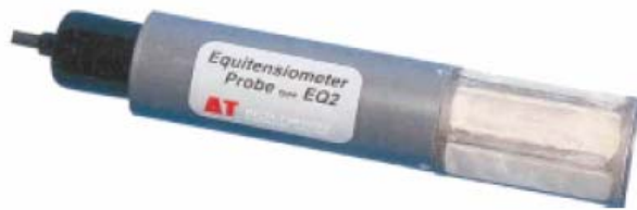
Şekil 2.32. 200 mm uzunluğunda ve 40 mm çapında bir equitensiyometre (Charlesworth, 2000)
