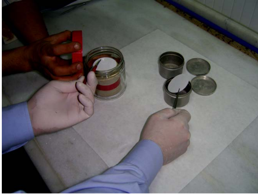
Şekil 3.23. Üstteki filtre kağıtlarının alüminyum kutulara alınması
