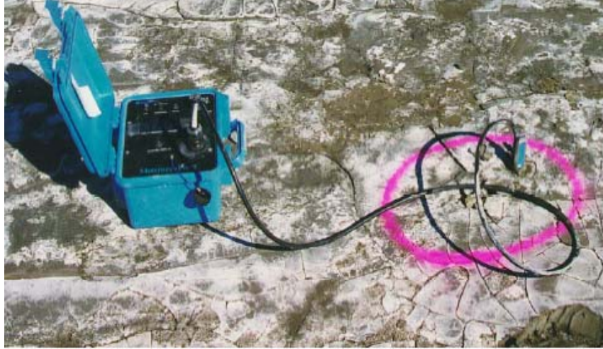
Şekil 2.35. TDR cihazı ile arazide su muhtevasının ölçülmesi (Jones ve Or, 2001)
