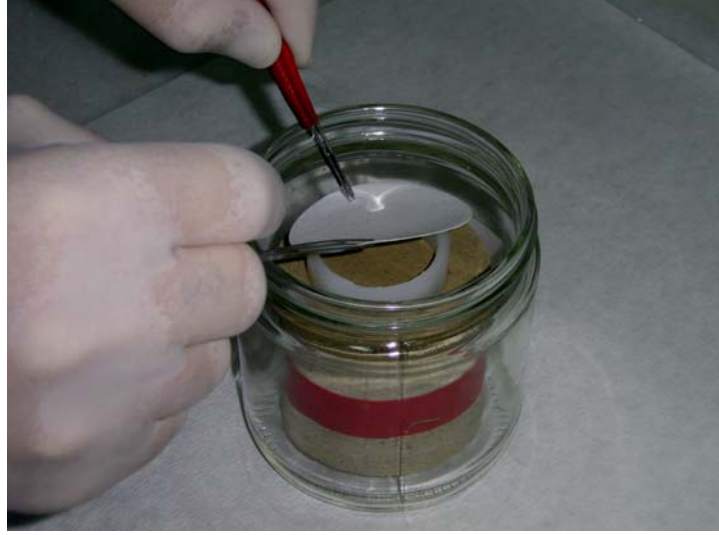
Şekil 3.20. O-ringin üzerine filtre kağıtlarının yerleştirilmesi
