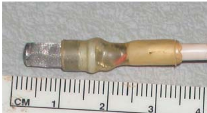
Şekil 2.24. Thermocouple saykrometrenin dış görüntüsü (Bulut ve Leong, 2005)
