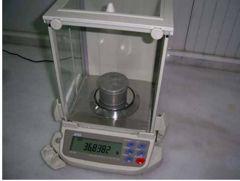
Şekil 3.26. Kuru ağırlıkların 0.0001 gr hassasiyetindeki terazi ile belirlenmesi
