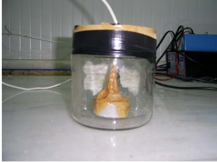
Şekil 3.11. Saykrometre deney numunelerinin kavanozlara yerleştirilmesi
