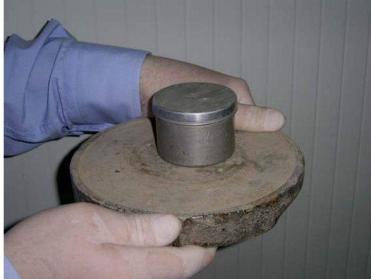
Şekil 3.25. Alüminyum numune kutusunun hızlı bir şekilde soğuması için bir metal blok üzerine yerleştirilmesi
