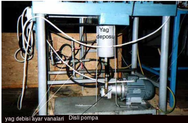
Şekil 3.36. Hidrolik donanım sistemi(Tüfekci, 2003)
