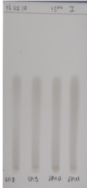
Şekil III.2. Mobil Faz: Toluen: Etilasetat: Formik asit: Metanol (20:40:8:2). Örnek konsantrasyonları: EA8: 5.8 \times 10^{-3} mol.L -1 EA9: 6.0 \times 10^{-3} mol.L -1 EA10: 8.3 \times 10^{-3} mol.L -1 EA11: 8.7 \times 10^{-3} mol.L -1 .
