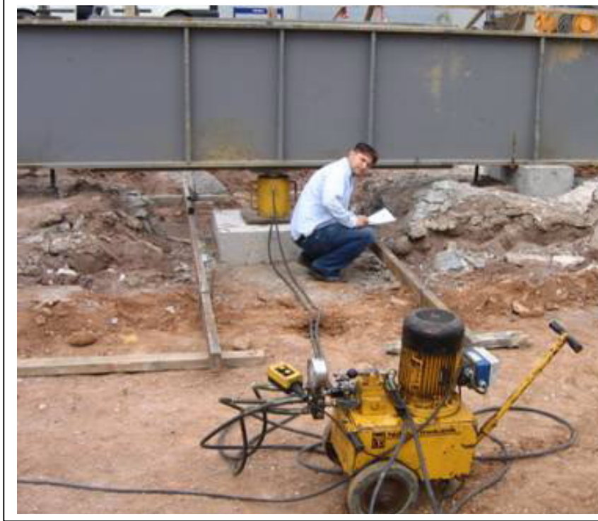
Şekil 3.7. Jet rout kolon yükleme deneyi test ekipmanları düzeneği
