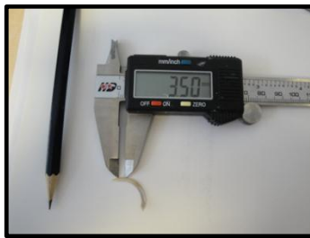
Resim 10: Kesici diřlerin dijital mikrometre kullanılarak iřaretlenmesi
