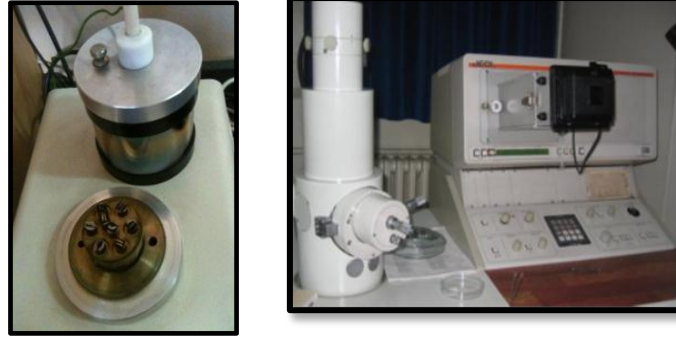
Resim 14: Örneklerin altın kaplanması ve SEM cihazı
