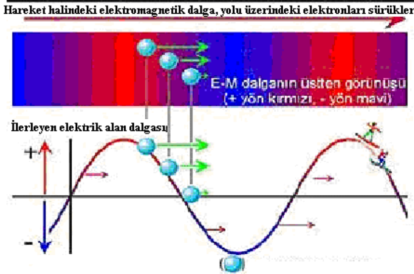
Şekil 3.5. Elektronlar ve hareket ettirici dalga arasındaki etkileşimi
