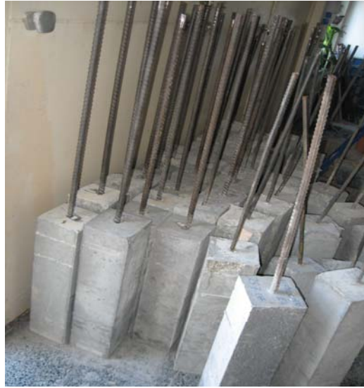
Şekil 3.4. Aderans deneyi uygulanmış ve uygulanmamış bazı numuneler
