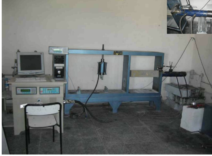
Şekil 3.5. Aderans deney çerçevesi ve aderans deneyinin yapılışı
