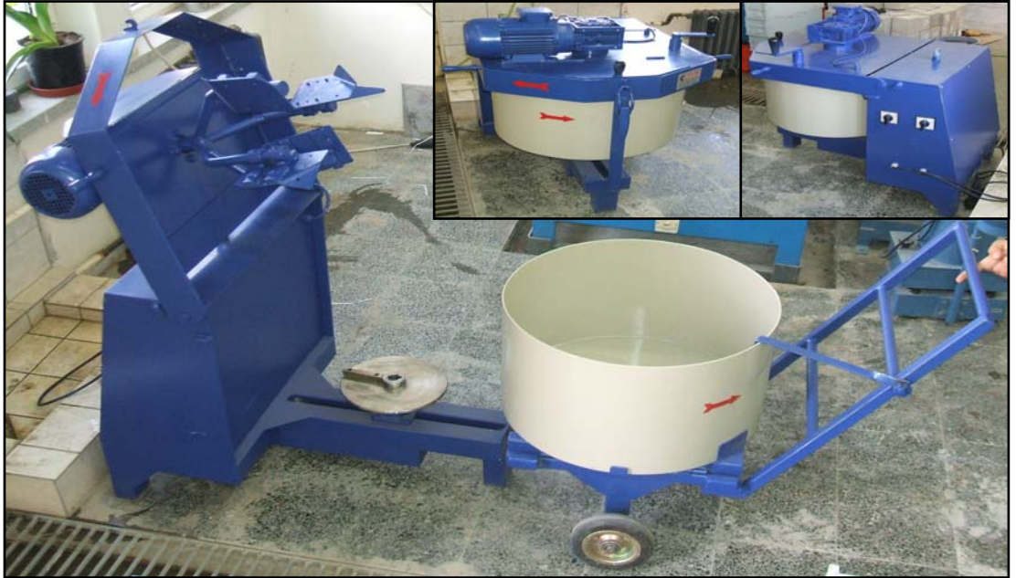
Şekil 3.1. Betonların üretildiği betoniyer
