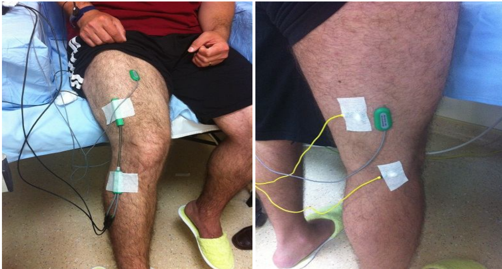
Şekil 3.3. EMG, goniometre ve topraklama problemlerinin bağlanması.
