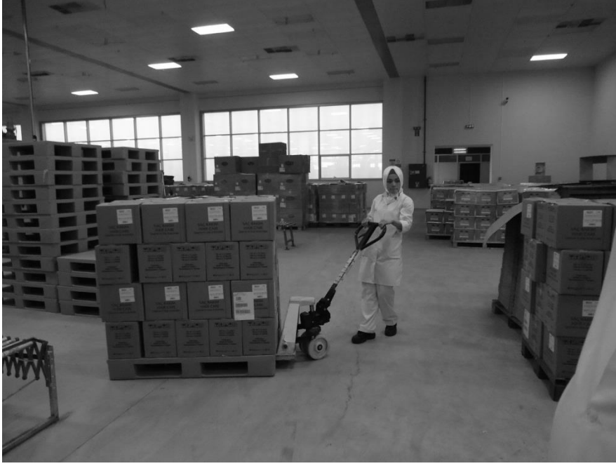
Resim 5.5.1.1.a.1: Resimde 54 koliden oluşan bir paletin kadın çalışan tarafından transpalet yardımı ile çekilmesi görülmektedir (454 kg).
