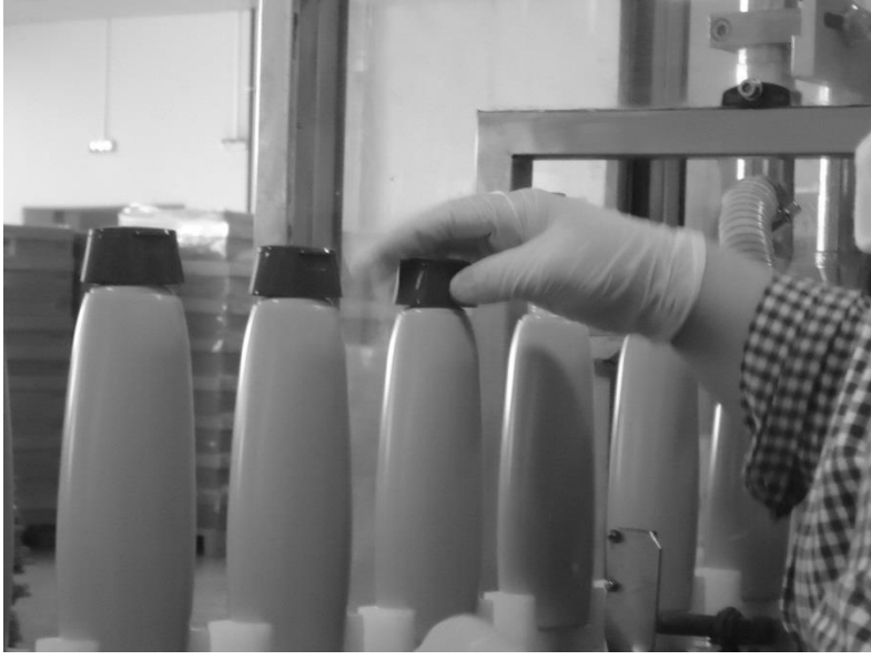
Resim 5.5.1.1.e.: Kadın çalışanlar güneş sütü ürünlerine kapak yerleştirirken. Kapağın yerine sabitlenmesi işlemi elle değil, makine tarafından yapılmaktadır.
