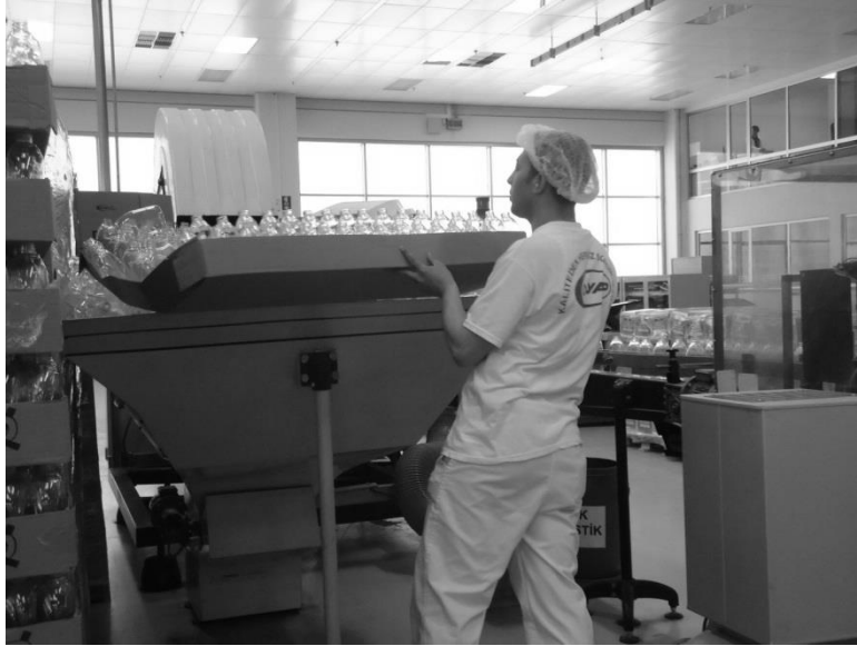
Resim 5.5.1.1.c.: Boş şişelerin “tava” adı verilen karton ambalaj yardımı ile makine besleme ağzına (posimata) dökülmesi.
