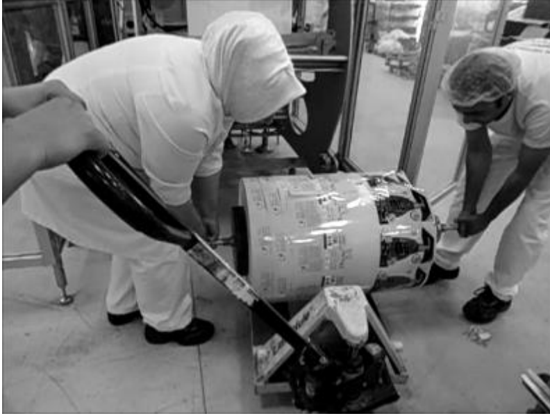
Resim 5.5.1.1.b.1: Transpalet yardımı ile getirilen silindirin orta demirinin takılması
