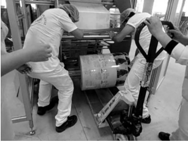
Resim 5.5.1.1.b.2: Yerden yaklaşık 50 cm yükseklikte bulunan bobin yuvasına 90 kg'lık silindirin elle yerleştirilmesi
