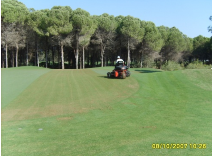
Şekil 2.6. Sueno Golf Hotel’de 1.5 – 1.6 m biçim genişliğine sahip üçlü silindri green çim biçme makinesi (Ömer Güntan’ın Arşivinden).
