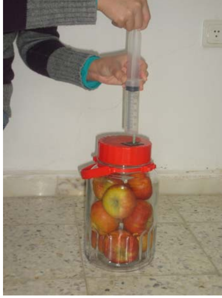
Şekil 3.18. Meyvelerin ağzı kapalı cam kavanozlarda 24 saat bekletilmesinden sonra kavanoz içinden enjektörle gaz örneğinin alınması
