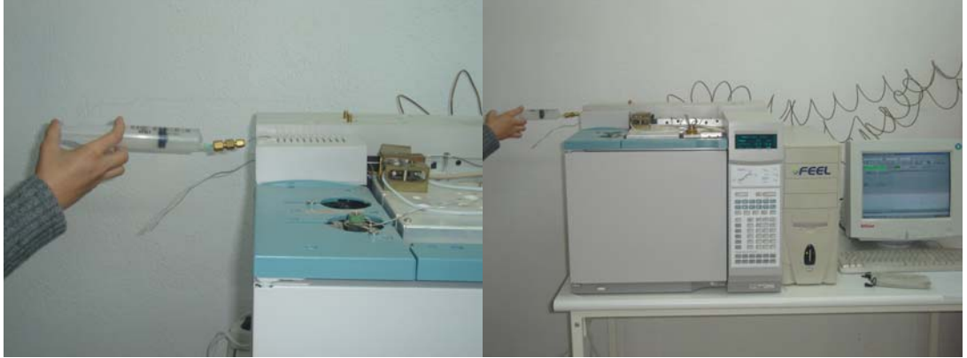
Şekil 3.19. Kavanozlardan alınan gaz örneklerinin solunum hızı ve etilen üretim miktarı ölçümü için gaz kromatografisine verilmesi
