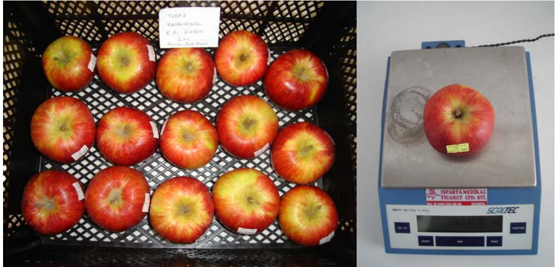
a b Şekil 3.14. Ağırlık kaybının belirlenmesi için etiketlenerek her bir depolama koşuluna yerleştirilen meyve örnekleri (a) ve analitik terazi ile meyve ağırlığı ölçümü (b)
