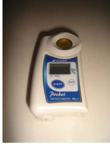
Şekil 3.20. Dijital refraktometreyle suda çözünen kuru madde içeriği ölçümü
