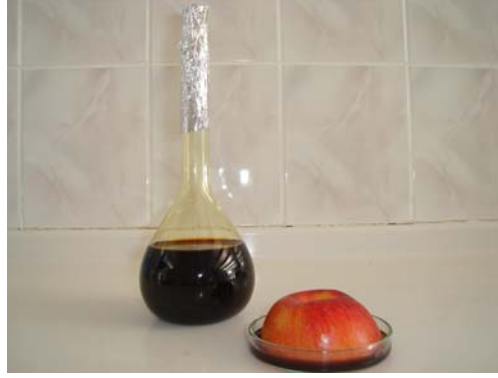
Şekil 3.25. Meyve nişasta içeriğinin IKI çözeltisiyle belirlenmesi
