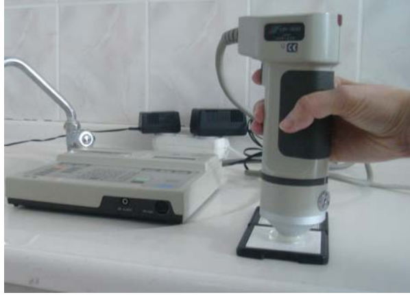
Şekil 3.22. Renk cihazının Minolta kalibrasyon plakası ile kalibrasyonu
