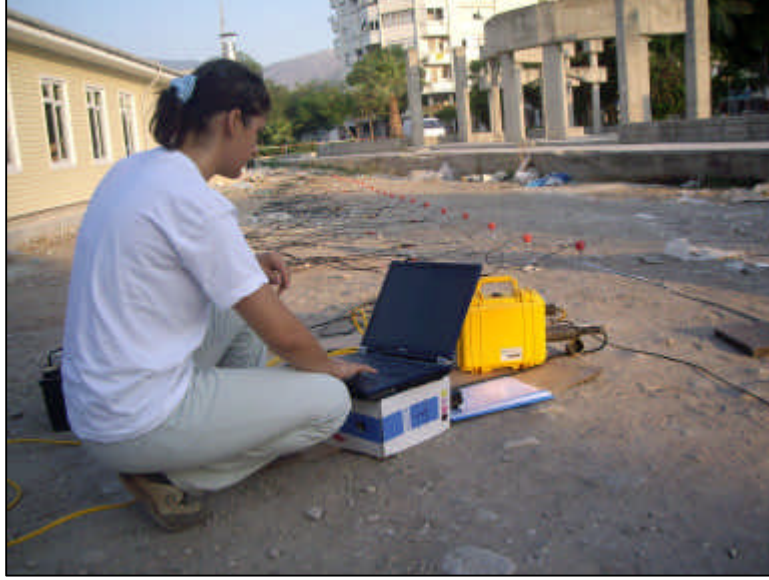
Sekil 3.22. YDÇAK yönteminde veri toplama düzeni
