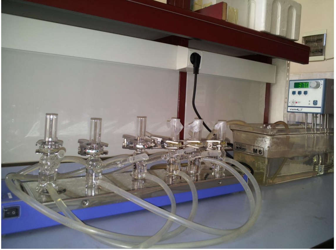
Resim 5.8. Çalışmada kullanılan Franz Difüzyon Hücreleri
