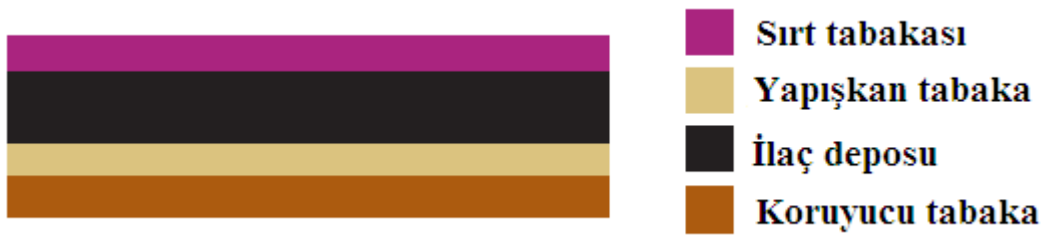
Şekil 4.7. Adeziv difüzyon kontrollü sistemin yapısı (59)
