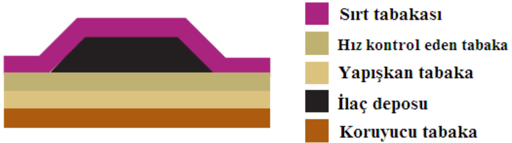
Şekil 4.5. Membran denetimli sistemin yapısı (59)
