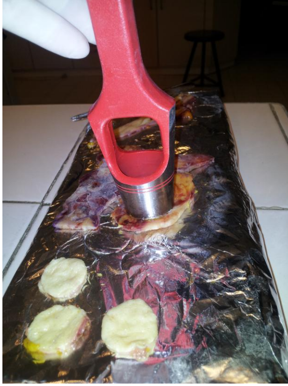
Resim 5.4. Deri zımbası yardımıyla derinin Franz difüzyon hücresi dış çapı ölçülerinde kesilmesi
