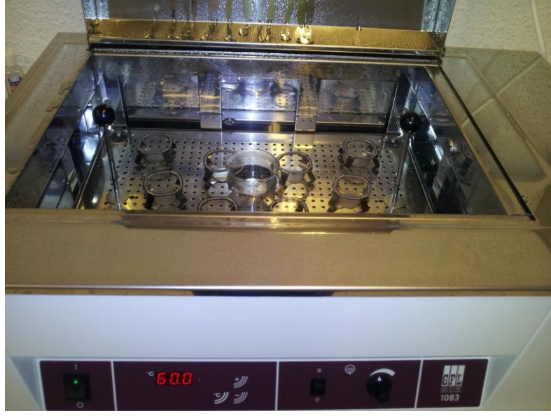
Resim 5.6. Derinin ayrılabilmesi için su banyosunda bekletilmesi
