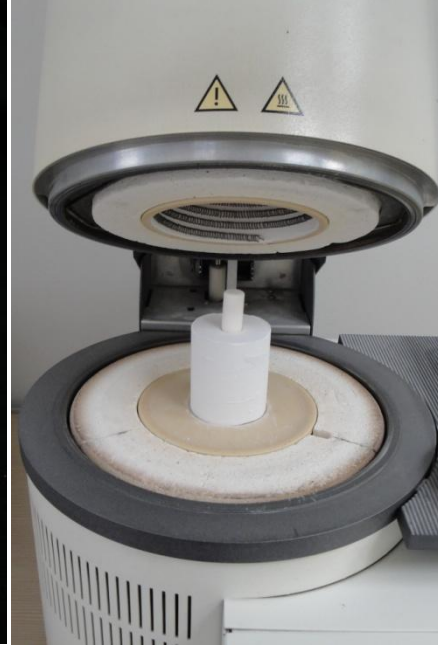
Resim 5.45 PoM ingotun revetmana yerleştirilmesi Resim 5.46 Presleme işlemi
