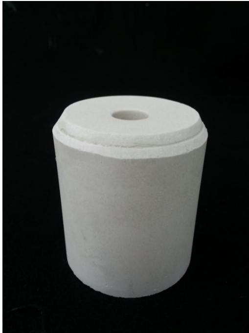
Resim 5.18 Modelajın revetmana alınması
