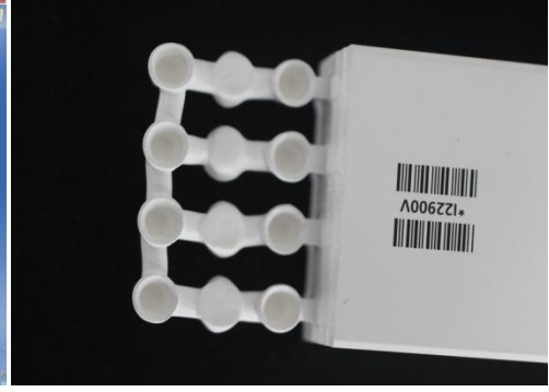
Resim 5.34 Kazıma işlemi tamamlanmış zirkonyum blok
