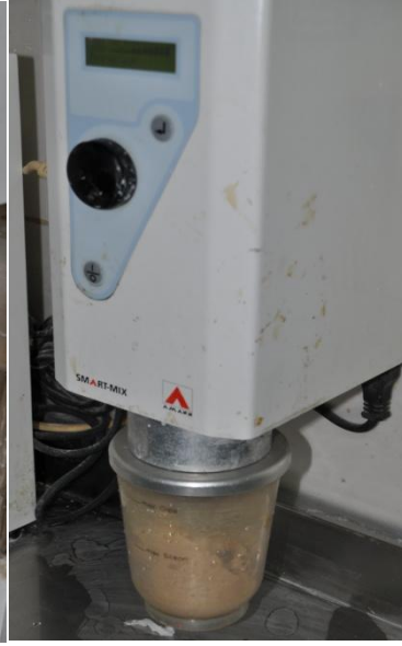
Resim 5.13 Smartmix alçı karıştırıcı
