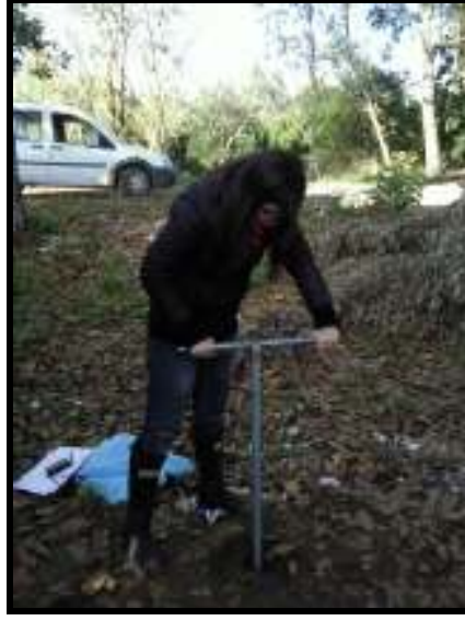
Şekil 3. 7. El burgusu ile örselenmiş numune alımı
