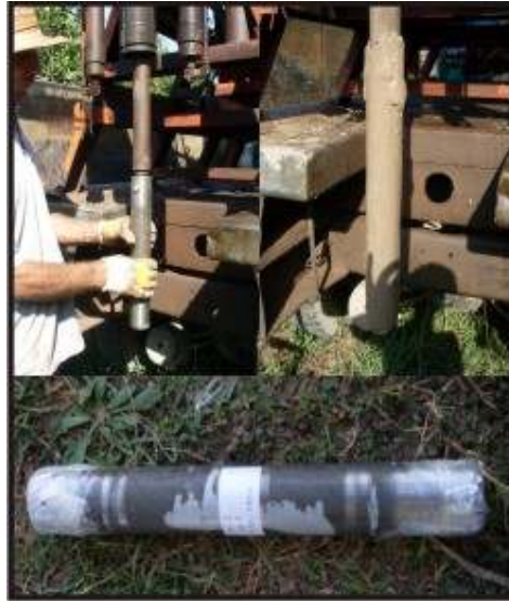
Şekil 3. 6. UD tüpü ile örselenmemiş numune alımı
