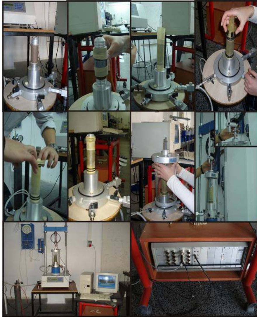
Şekil 3.12. Üç eksenli basınç deneyinde deney düzeneğinin hazırlanması
