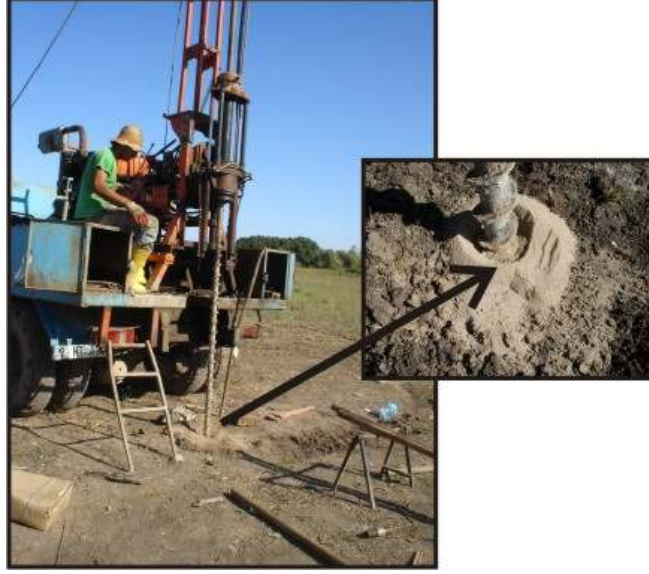
Şekil 3. 3. Rotary tipi sondaj sisteminde auger ile kuyu açılması
