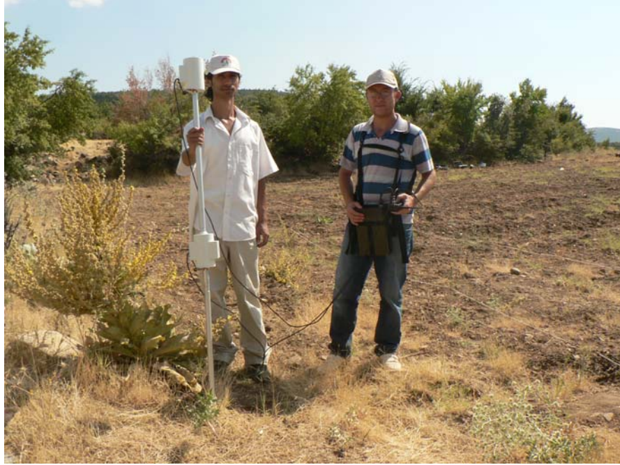
Şekil 3.6. Manyetik yöntemde gradient tekniği ile ölçü alımı
