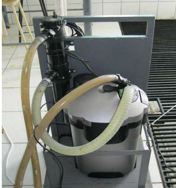
Şekil 3.6. Arařtırmada sterilizasyon amacıyla kullanılan U.V. filtre
