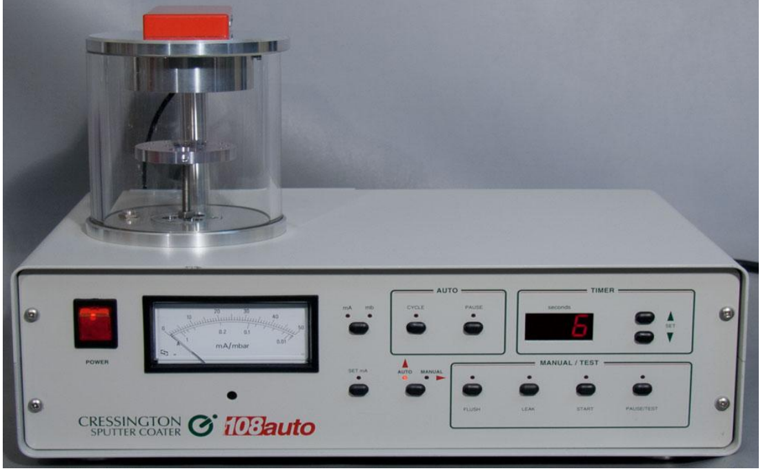
Resim 17. Metal sıçratma kaplama cihazı (Cressington 108 Sputter Coater, USA)
