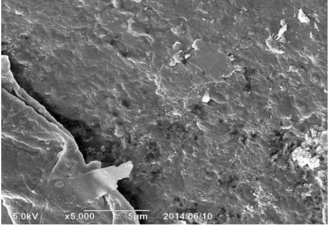
Resim 62. pH dngs ile Tooth Mousse uygulanan mine yzeyinin 5000x bytmede SEM-SE grnts
