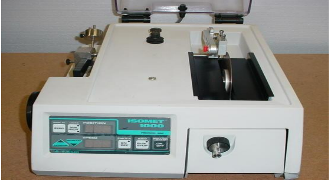
Resim 6. ISOMET kesme cihazı (Buehler Ltd., Lake Bluff, IL, ABD)
