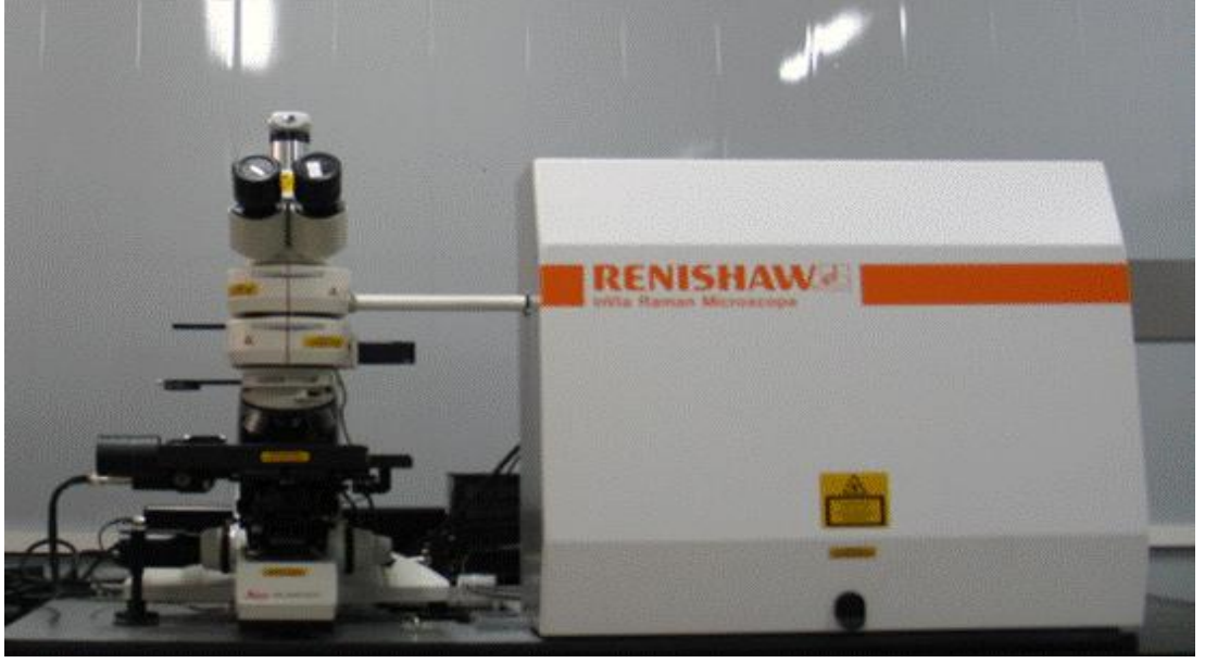
Resim 10. Raman Spektroskopi cihazı (Renishaw InVia Raman Microscope, UK)
