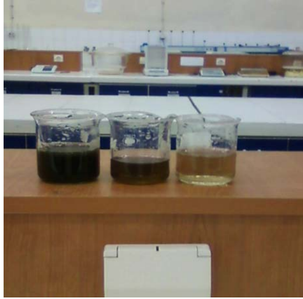
Şekil 4.8. Karasu numunesinin doğal hali ve adsorban miktarının 0.01g (ortada) ve 0,1g PSAC ile adsorbe edilmiş görüntüsü.
