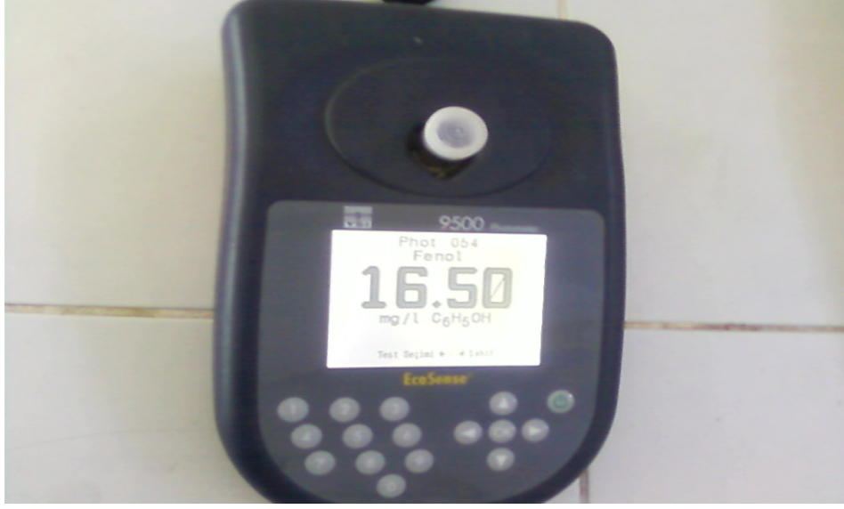
Şekil 3.3. YSI 9500 marka atıksu analiz spektrofotometresi ile karasu için fenol ölçümü.
