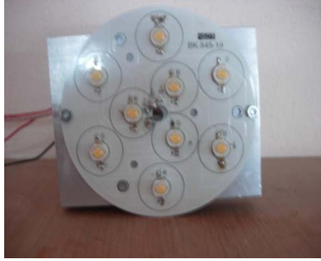
Şekil 3.8. Baskılı devre kartı üzerine yerleştirilmiş 9 adet kırmızı LED'ten oluşan aydınlatma sistemi
