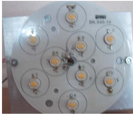
Şekil 3.9. Baskılı devre kartı üzerine yerleştirilmiş 9 adet mavi LED'ten oluşan aydınlatma sistemi
