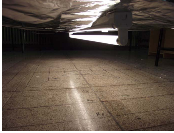
Şekil 3.13. Flüorışıl lambanın belirli yükseklikte sağlayabileceği FAR değerlerinin dağılımını belirlemek için kullanılan test düzeneği
