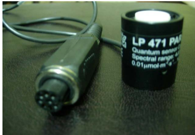
Şekil 3.2. FAR sensörü (LP 471PHOTO, DELTA OHM)
