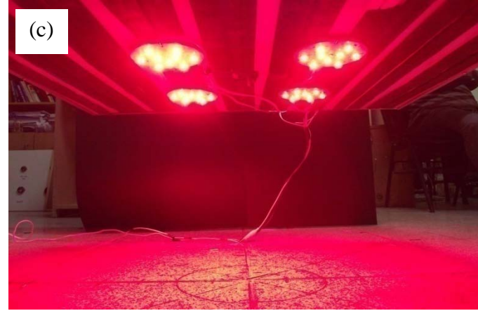
Şekil 3.11. LED aydınlatma sistemlerinin yerleşim geometrisinin belirlenmesinde kullanılan test düzeneği
