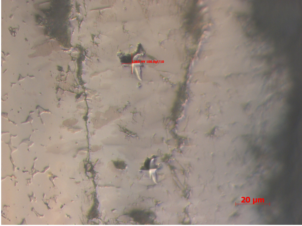
Şekil 4.34. AISI 1050'ye ait kaplama sertliği (1365 HV)
