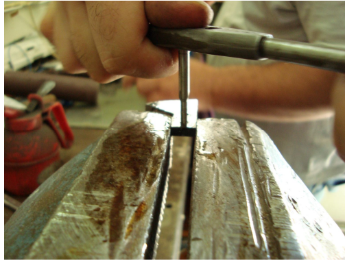
řekil 3.8. Kılavuzlama iřlemi ile civata yatakları aılan numuneler
