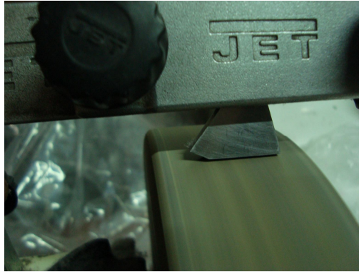
řekil 3.7. Tařlama ile istenilen kesme yzeyi elde edilen numuneler
