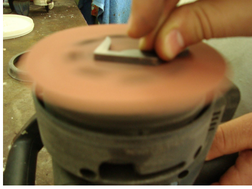
řekil 3.6. Zımpara iřlemi ile apaklarının alınan numuneler
