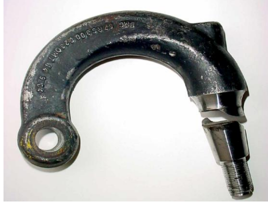
Şekil 1.4. Hasarlı çolak kolu (Gökşenli vd., 2007)
