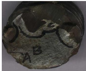
Şekil 2.4. Civatada kırılmış yüzeyler (Chen vd., 2006)
