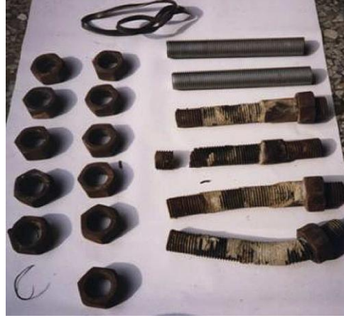
Şekil 2.3. Kırık cıvata resimleri (Chen vd., 2006)
