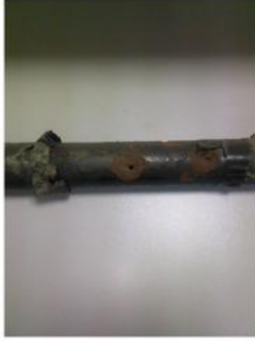
Şekil 1.12. Korozyona uğramış doğal gaz borusu ( http://www.igdas.com.tr )
