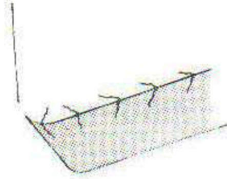
Şekil 1.24. Termal çatlak (Böhler, 1990)
