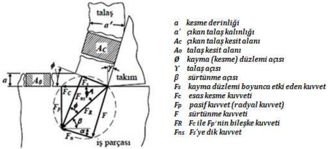
Şekil 1.11. Dik kesmede oluşan kuvvetler (Donaldson, 1980)
