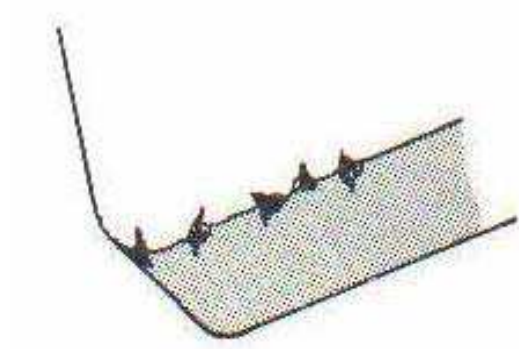
Şekil 1.25. Çentik aşınması (Böhler, 1990)
