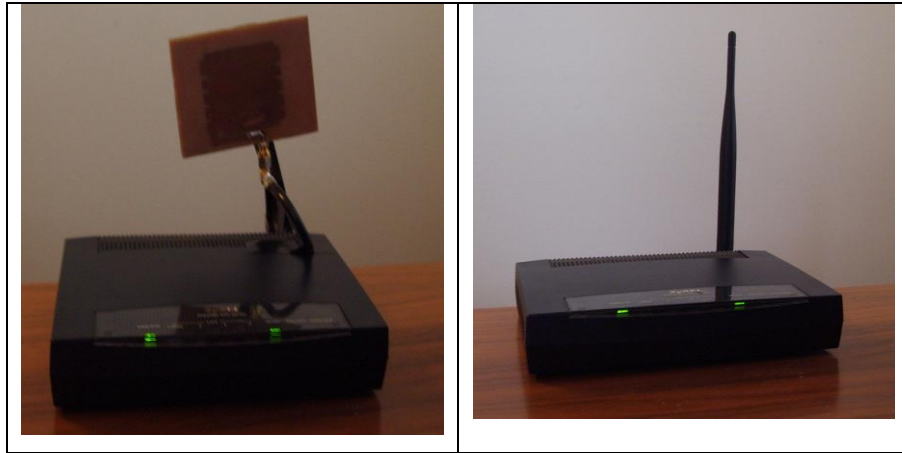
Şekil 4.19. Alıcı-Verici sistem ile antenin bağlantısı
