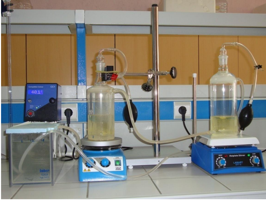
Şekil 3.2. Enzimatik interesterifikasyon için kullanılan çift cidarlı cam reaktör
