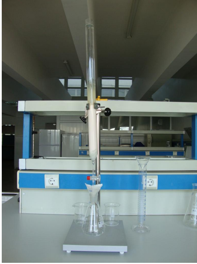
Şekil 3.4. Yapılandırılmış yağın kolon kromatografisi ile saflaştırılması
