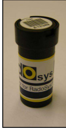
Şekil 3.1. CR-39 nükleer iz dedektörü bulunduran difüzyon kabı (Karadem, 2011)
