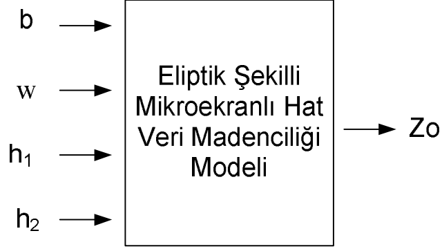
Şekil 3.10. Eliptik şekilli mikroekranlı hattın blok şeması
