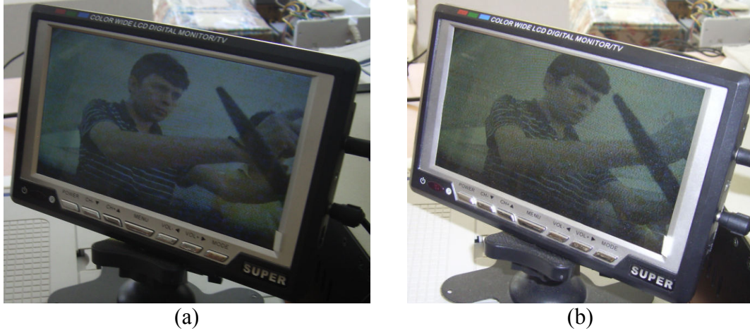
Şekil 4.28. (a) AGC kontrollü PA kullanılan sistem uygulaması (b) AGC kontrollü PA kullanılmayan sistem uygulaması
