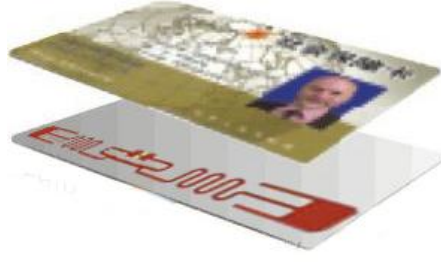
Şekil 4.6. RFID etiketin yerleştirileceği personel kartlarının yapısı
