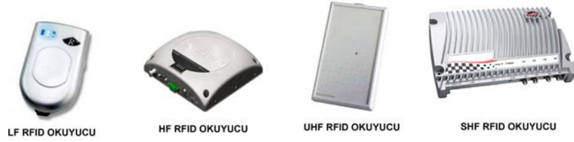
Şekil 3.13. Farklı frekanslarda çalışan RFID okuyucular (Saleh ve Alsmadi, 2010)
