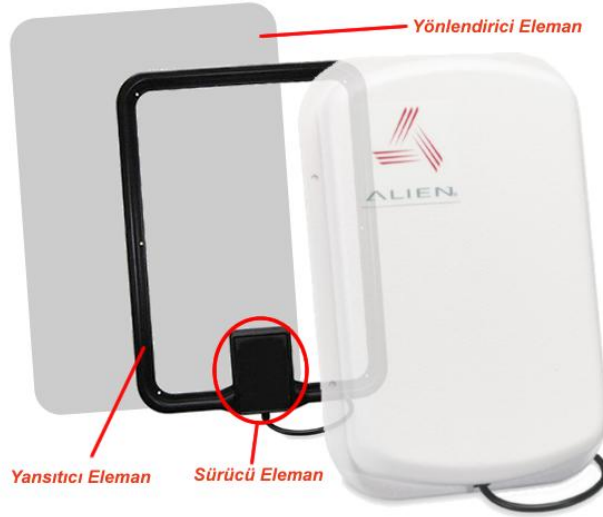
Şekil 3. 9. RFID anteni oluşturan bileşenler
