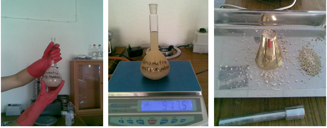
Şekil 3.10. Piknometre yönteminde taneler arasındaki hava boşluklarının alınması
