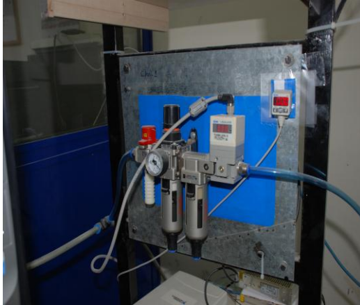
Şekil 3.21. Hücre basıncını ayarlayan regülatör
