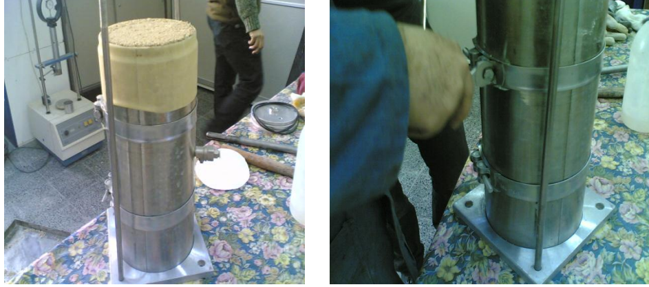
Şekil 3.22. 15 cm çapında 30cm yüksekliğinde ayrılabilir 2 parçalı kalıp
