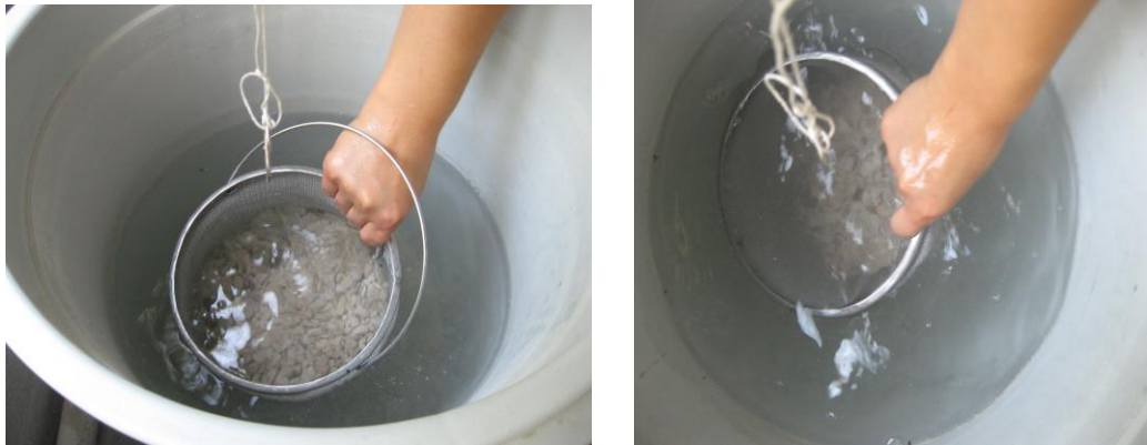
Şekil 3.7. Numunenin suya daldırılması ve hava kabarcıklarının alınması
