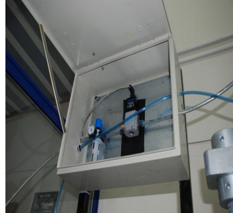
Şekil 3.21. Hücre basıncını ayarlayan regülatör
