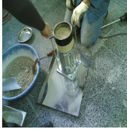
Şekil 3.24. Latex membran içinde hazırlanmış numune ve üst başlığı
