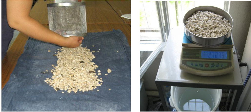
Şekil 3.8. Tel Sepet metodunda agregaların kurutulması işlemi
