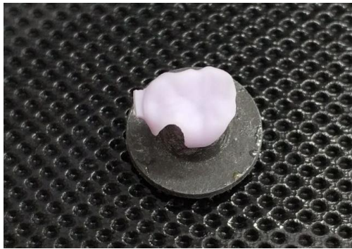
Resim 5.6. Frezelenen prekristalize IPS e.max CAD restorasyonu
