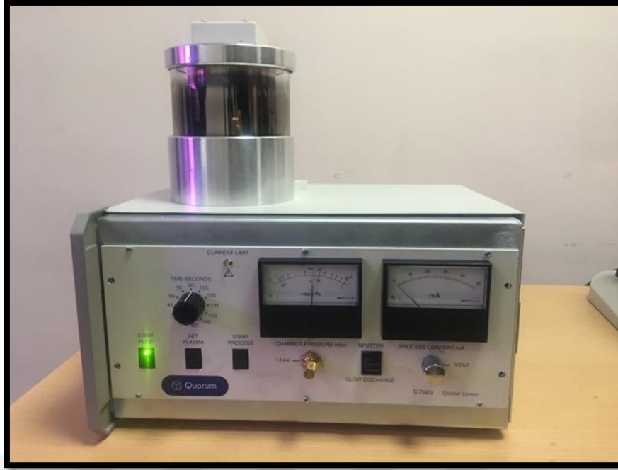
Resim 5.11. Altın püskürtme cihazı (Quorum Sputter Coater SC7620, Quorum Technologies, Sussex, İngiltere)
