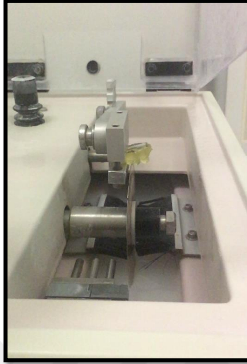
Resim 5.10. Hassas kesim cihazıyla replikaların mezio-distal yönde kesilmesi
