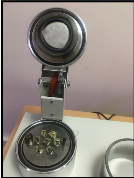
Resim 5.12., Resim 5.13. Altın püskürtmesi tamamlanan epoksi replikalar
