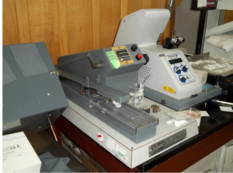
Şekil 3.15. Elmatear sürtme test cihazı
