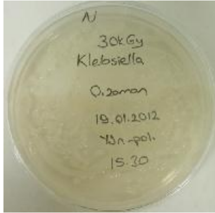
Şekil 4.53. K. pneumoniae uygulanmış ve 30 kGy dozunda ışınlanmış yün-poliester kumaş (AATCC 100 test metodu) (0.zaman)
