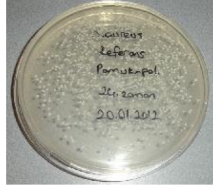
Şekil 4.26. S. aureus uygulanmış pamuk-poliester referans kumaş (AATCC 100 test metodu) (24.zaman)
