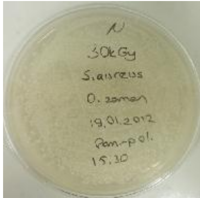
Şekil 4.29. S. aureus uygulanmış ve 30 kGy dozunda ışınlanmış pamuk-poliester kumaş (AATCC 100 test metodu) (0.zaman)
