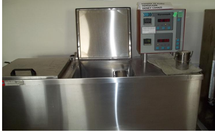
Şekil 3.11. Gyrowash yıkama haslıđı test cihazı
