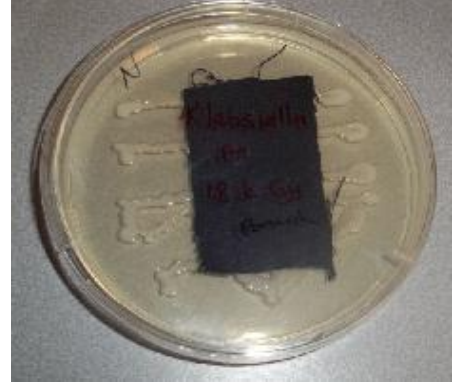
Şekil 4.4. K. pneumoniae uygulanmış ve 18 kGy dozunda ışınlanmış % 100 pamuk kumaş (AATCC 147 test metodu)
