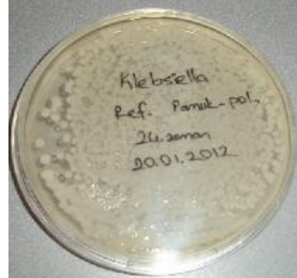
Şekil 4.32. K. pneumoniae uygulanmış pamuk-poliester referans kumaş (AATCC 100 test metodu) (24.zaman)
