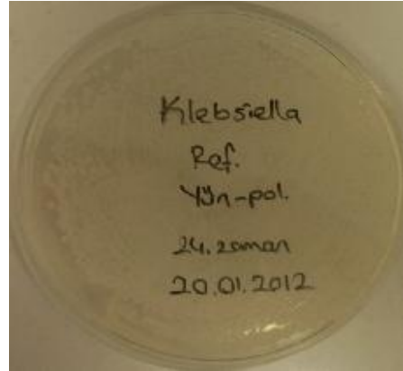
Şekil 4.50. K. pneumoniae uygulanmış yün-poliester referans kumaş (AATCC 100 test metodu) (24.zaman)
