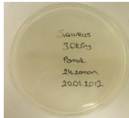
Şekil 4.12. S. aureus uygulanmış ve 30 kGy dozunda ışınlanmış % 100 pamuk kumaş (AATCC 100 test metodu) (24.zaman)
