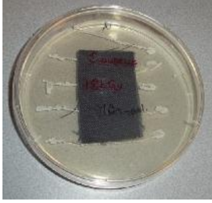
Şekil 4.39. S. aureus uygulanmış ve 18 kGy dozunda ışınlanmış yün-poliester kumaş (AATCC 147 test metodu)
