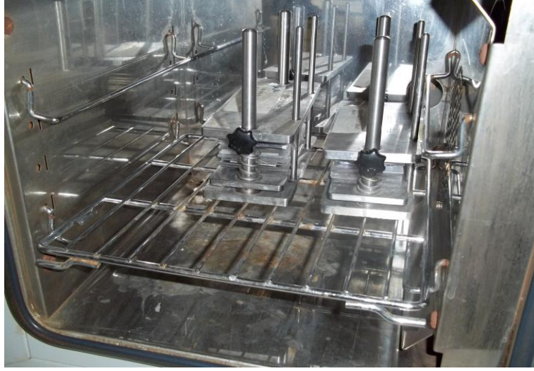
Şekil 3.17. Sıkıştırılan perspirometreler arasındaki numune kumaşların etüv içindeki görünümü
