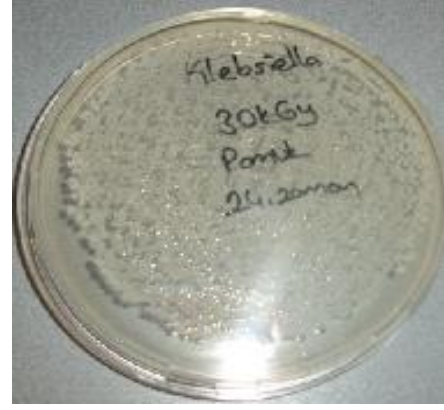
Şekil 4.18. K. pneumoniae uygulanmış ve 30 kGy dozunda ışınlanmış % 100 pamuk kumaş (AATCC 100 test metodu) (24.zaman)
