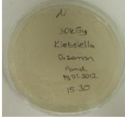
Şekil 4.17. K. pneumoniae uygulanmış ve 30 kGy dozunda ışınlanmış % 100 pamuk kumaş (AATCC 100 test metodu) (0.zaman)
