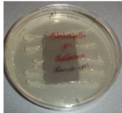
Şekil 4.20. K. pneumoniae uygulanmış pamuk-poliester referans kumaş (AATCC 147 test metodu)
