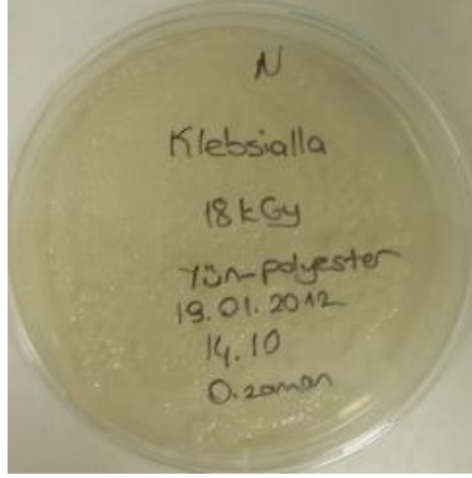
Şekil 4.51. K. pneumoniae uygulanmış ve 18 kGy dozunda ışınlanmış yün-poliester kumaş (AATCC 100 test metodu) (0.zaman)
