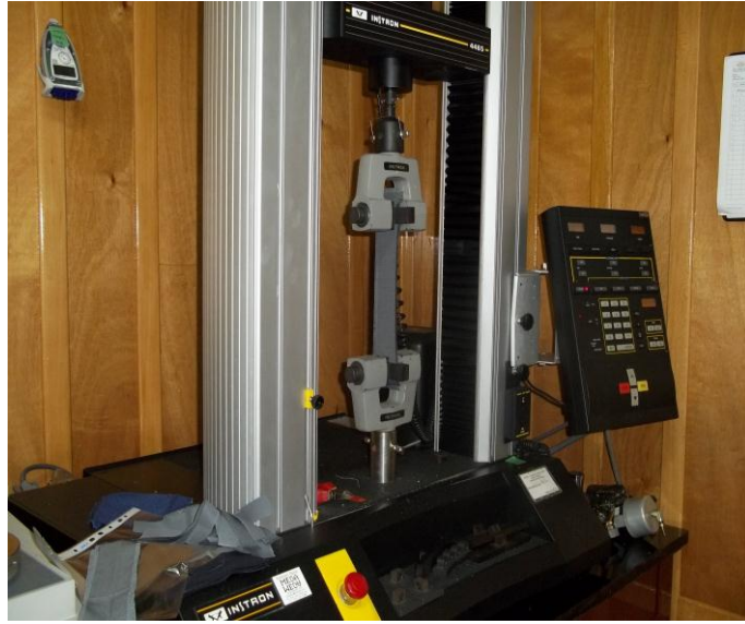
Şekil 3.8. Instron kopma mukavemeti test cihazı
