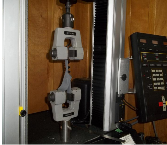
Şekil 3.9. Instron yırtılma mukavemeti test cihazı
