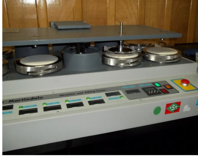
Şekil 3.10. Martindale boncuklanma test cihazı
