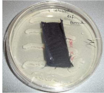
Şekil 4.2. K. pneumoniae uygulanmış % 100 pamuk referans kumaş (AATCC 147 test metodu)
