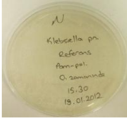
Şekil 4.31. K. pneumoniae uygulanmış pamuk-poliester referans kumaş (AATCC 100 test metodu) (0.zaman)
