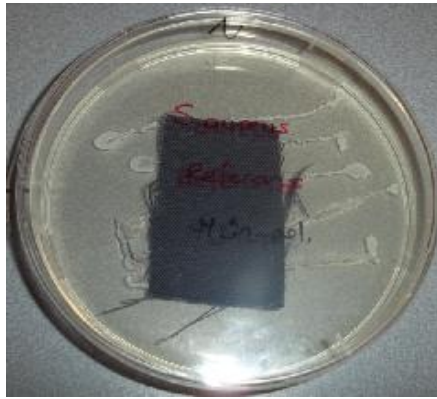
Şekil 4.37. S. aureus uygulanmış yün-poliester referans kumaş (AATCC 147 test metodu)
