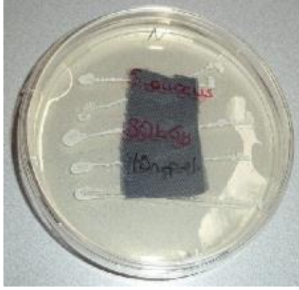
Şekil 4.41. S. aureus uygulanmış ve 30 kGy dozunda ışınlanmış yün-poliester kumaş (AATCC 147 test metodu)
