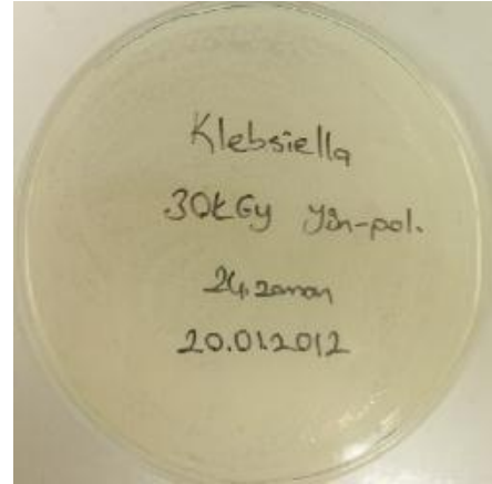
Şekil 4.54. K. pneumoniae uygulanmış ve 30 kGy dozunda ışınlanmış yün-poliester kumaş (AATCC 100 test metodu) (24.zaman)
