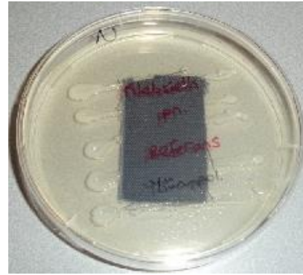
Şekil 4.38. K. pneumoniae uygulanmış yün-poliester referans kumaş (AATCC 147 test metodu)
