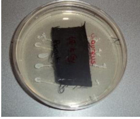
Şekil 4.3. S. aureus uygulanmış ve 18 kGy dozunda ışınlanmış % 100 pamuk kumaş (AATCC 147 test metodu)
