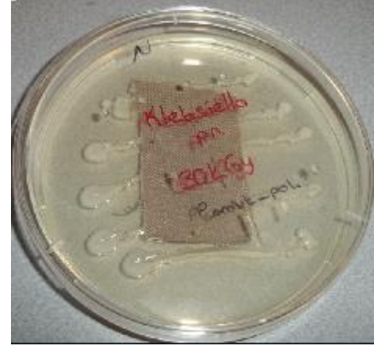
Şekil 4.24. K. pneumoniae uygulanmış ve 30 kGy dozunda ışınlanmış pamuk-poliester kumaş (AATCC 147 test metodu)
