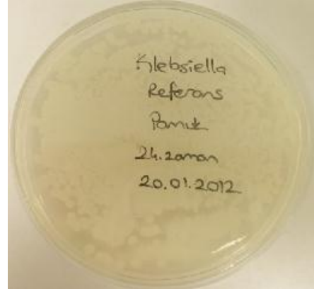
Şekil 4.14. K. pneumoniae uygulanmış % 100 pamuk referans kumaş (AATCC 100 test metodu) (24.zaman)
