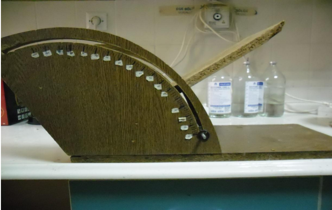
Şekil 8: tırmanma açısı ölçüm cihazı(eğimli yüzey tutunma)
